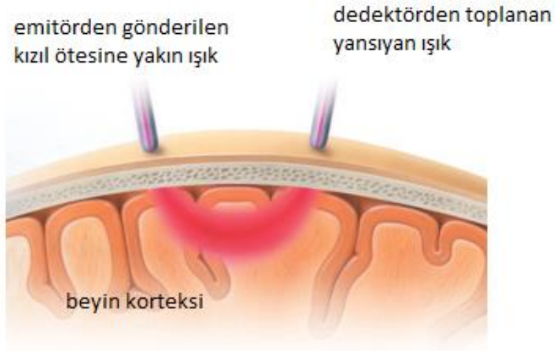
Şekil 3.1. NIRS çalışma prensibi
