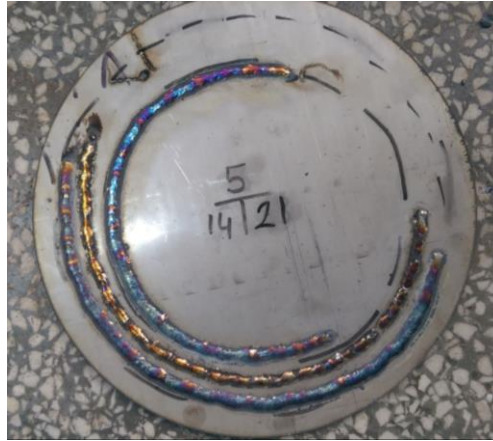
Şekil 3.6 Deneyler için kullanılan 316L paslanmaz çelik plaka
