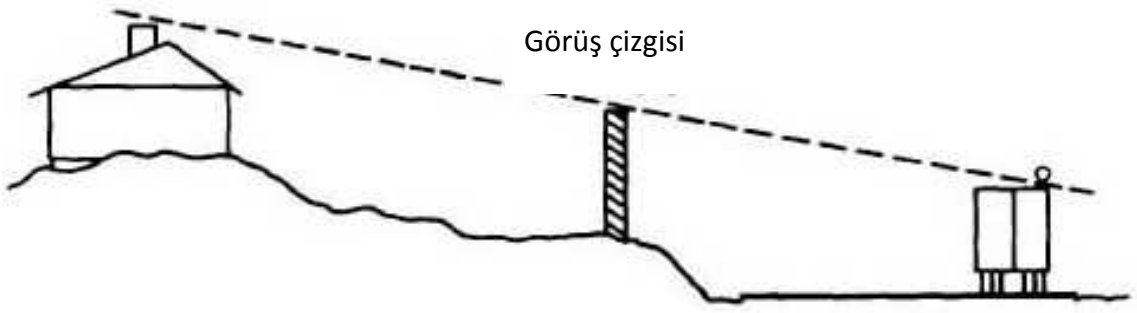
Şekil 2. 24 Engelin etkinliği için kaynağın en yüksek noktası ile alıcının en yüksek noktası arasındaki görüş çizgisini kapatması [38].
