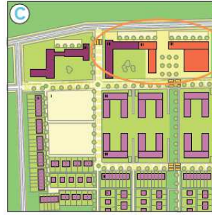
Şekil 2. 8 Yapıların uzatılarak gürültü azaltımı sağlanması [66]
