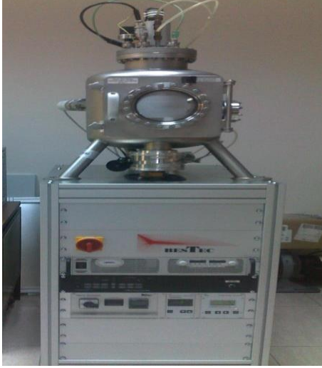
Resim 6.3. BESTEC marka yüksek vakum termal buharlaştırma sistemi
