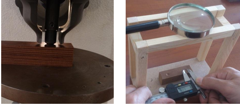
Resim 4.9. Brinell sertlik deneyi ve çukur çaplarının ölçülmesi
