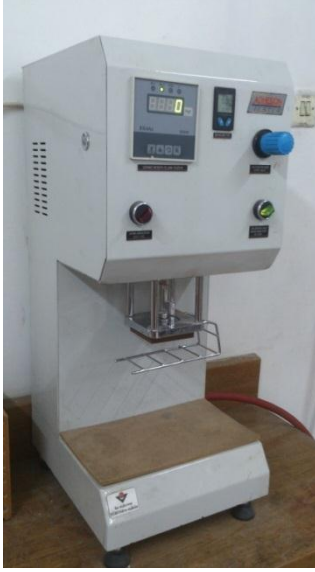
Resim 4.14. Adezyon test cihazı
