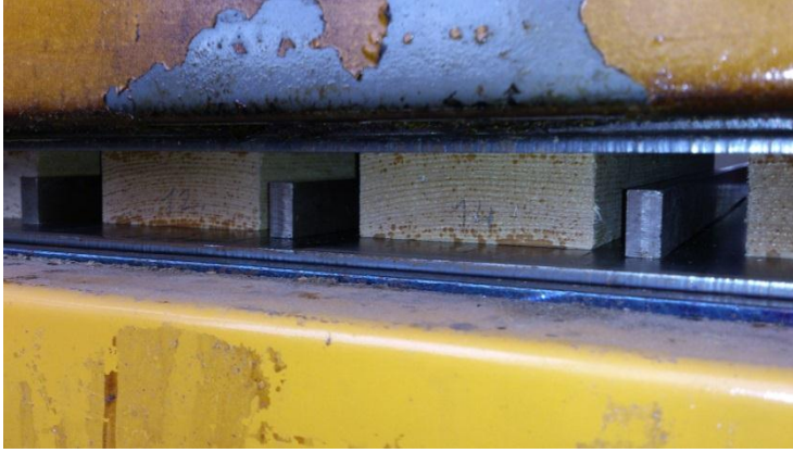
Resim 4.3. Sıkıştırma öncesi örneklerin sıcak preste ısıtılması ve metal stoplayıcı çıtaların konumu
