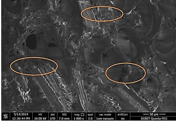
Resim 5.7. 210 °C ısıtılmış Doğu kayını SEM görüntüsü
