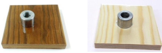
Resim 4.16. Deney silindirinin ilkbahar ve yaz odunu dengelemesine dikkat edilerek yapıştırılması
