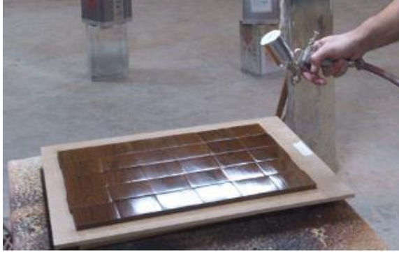
Resim 4.4. Püskürtme-sis tabancası ile vernik uygulaması
