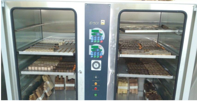
Resim 4.6. Örneklerin 20\pm 2 °C sıcaklık ve \%65\pm 5 bağıl nem şartlarında kondisyonlanması
