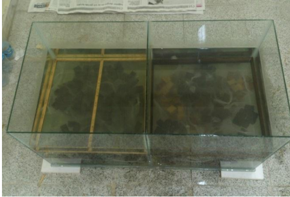
Resim 4.5. Deney örneklerinin su içerisinde bekletilmesi
