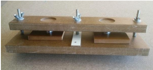
Resim 4.15. Deney silindirinin kalıp yardımı ile katmana yapıştırılması
