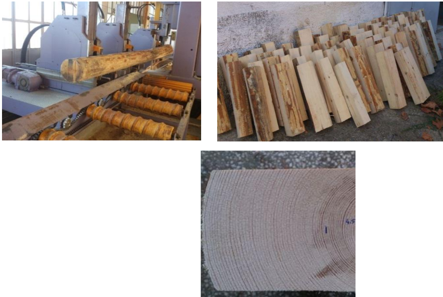
Resim 4.1. Tomrukların kaba ölçülerde kerestelere dönüştürülmesi
