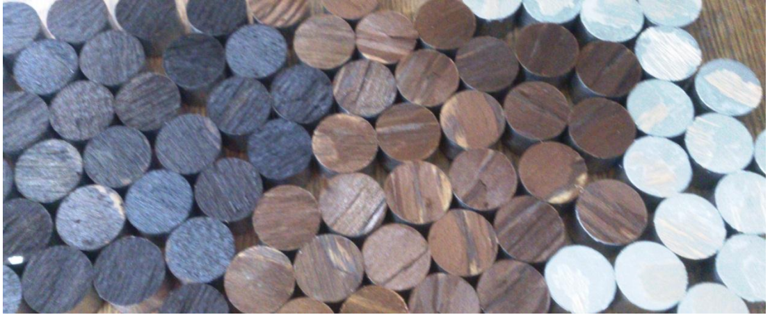
Resim 1.2. Isıl işlemsiz ve 210 °C sıcaklıkta ısıl işlem görmüş sarıçam ve Doğu kayını örneklerinde vernik katmanlarının yüzeye yapışma direnci testi sonrası çekme silindirlerinin görünümü
