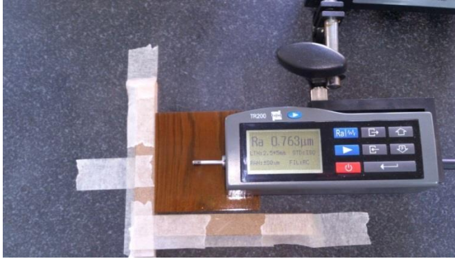
Resim 4.11. Yüzey pürüzlülük ölçümü
