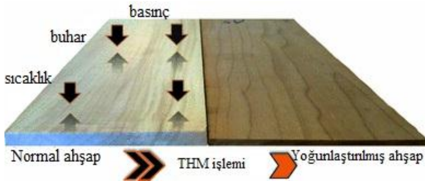
Şekil 2.5. THM yoğunlaştırma işlemi [Ahmed ve ark., 2013].
