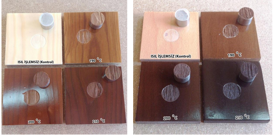
Resim 1.1. Isıl işlemsiz ve farklı sıcaklıklarda ısıl işlem görmüş sarıçam (sol) ve Doğu kayını (sağ) örneklerinde vernik katmanlarının yüzeye yapışma direnci testi sonrası oluşan durum
