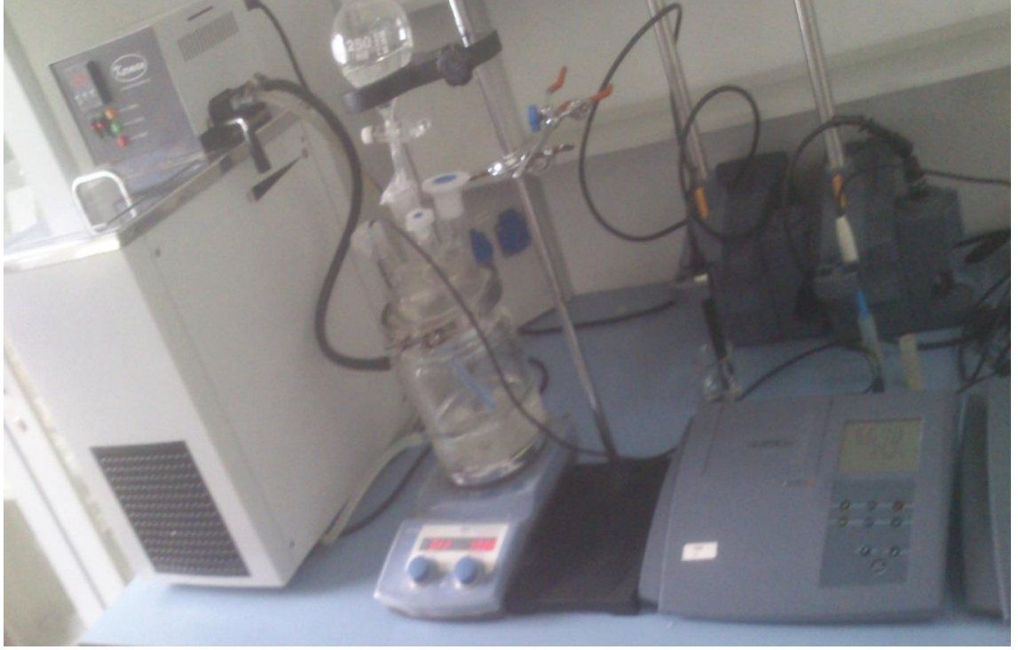
Şekil 5. 2 Baryum sülfat kristalizasyon deney düzeneği
