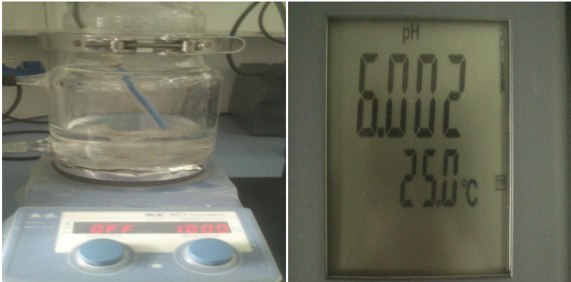
Şekil 5. 1 Manyetik karıştırma hızı, pH ve sıcaklık kontrolü
