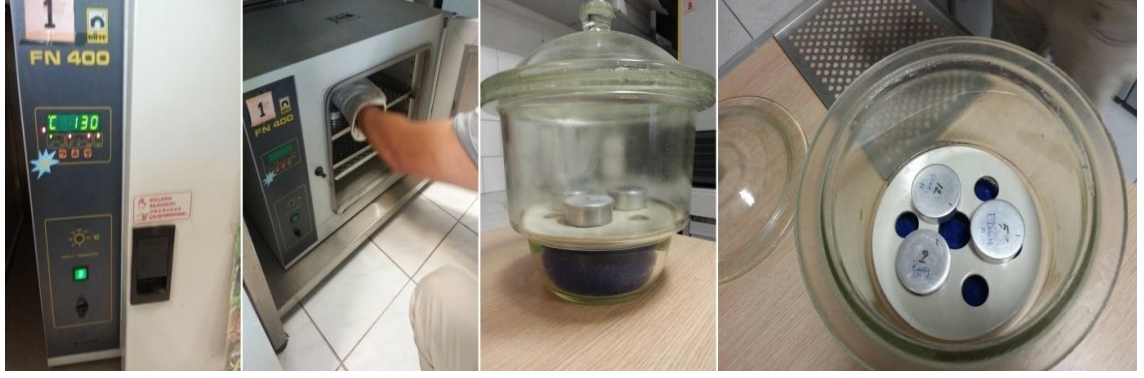
Şekil 3.6 Tohum neminin ölçülmesi
