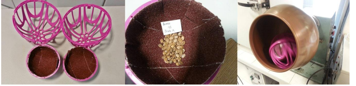
Şekil 3.2 Kaplama kazanında zımpara kağıdı ile mekanik aşındırma
