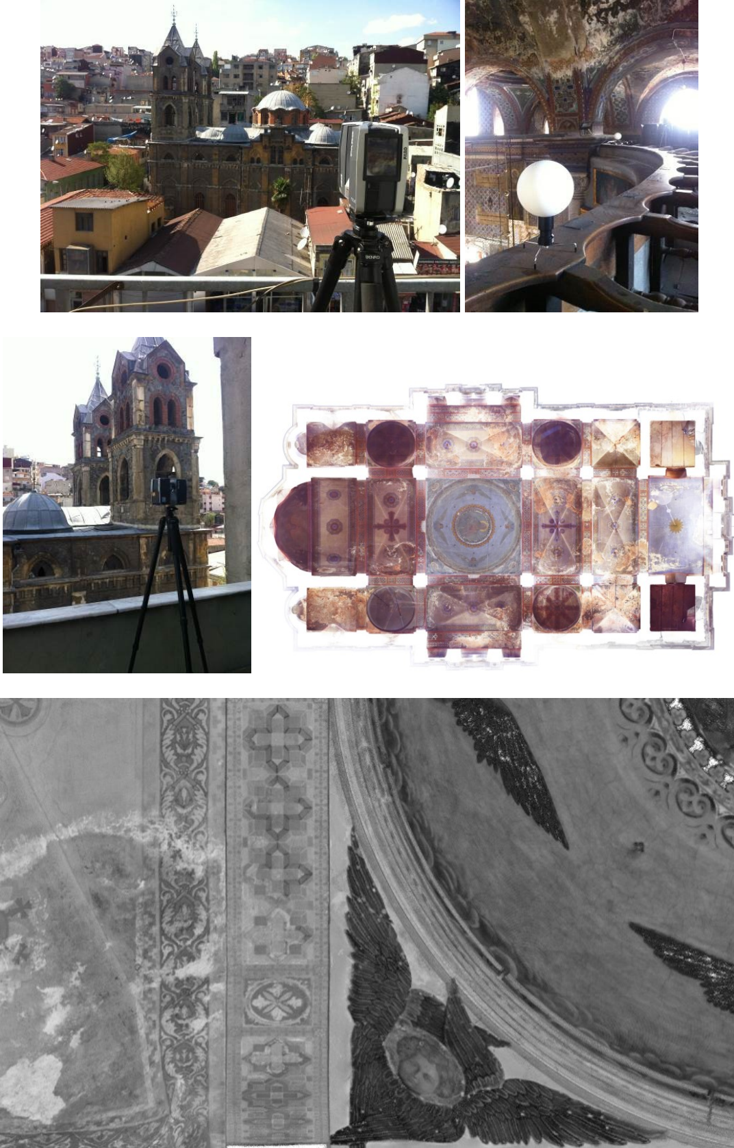
Şekil 4.37 : Evangelistria Kilisesi’nde 3 boyutlu lazer tarama yöntemi ile yapılan tonoz – kubbe izdüşüm ölçümleri sırasında çekilen fotoğraflar ve tavandan ortofoto detayı.
