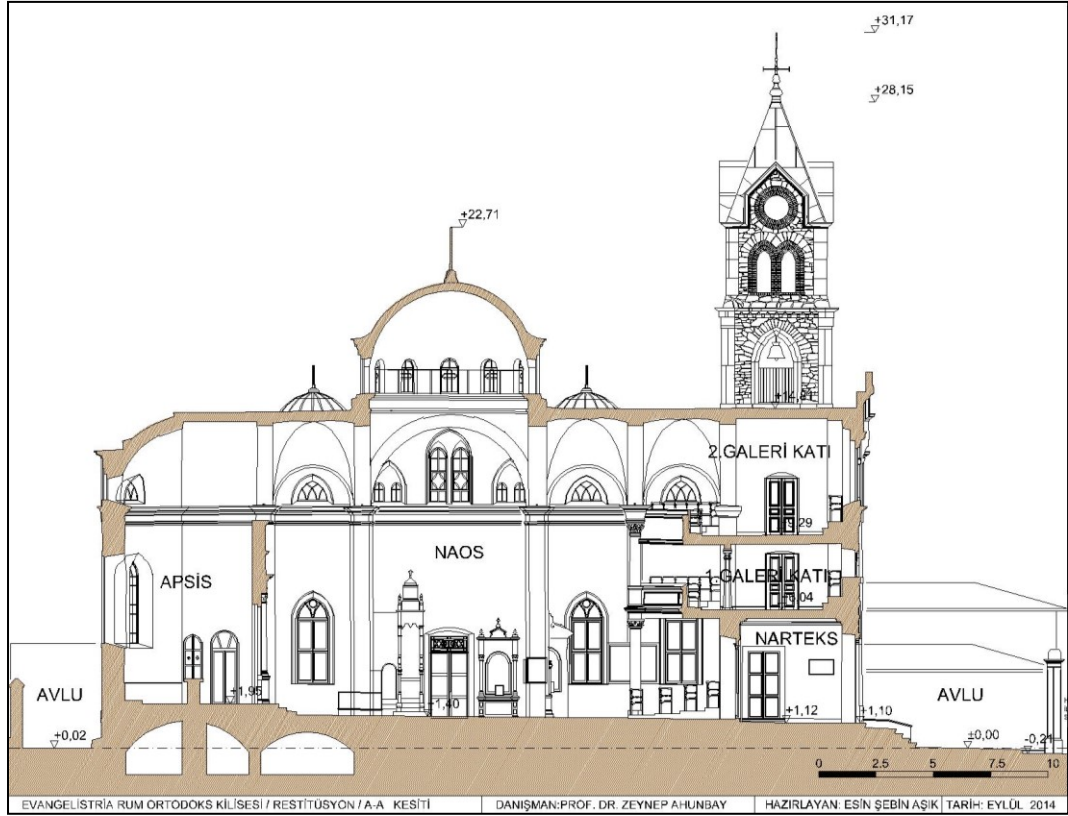
Şekil 4.264 : Evangelistria Kilisesi A-A kesiti, restitüsyon.
