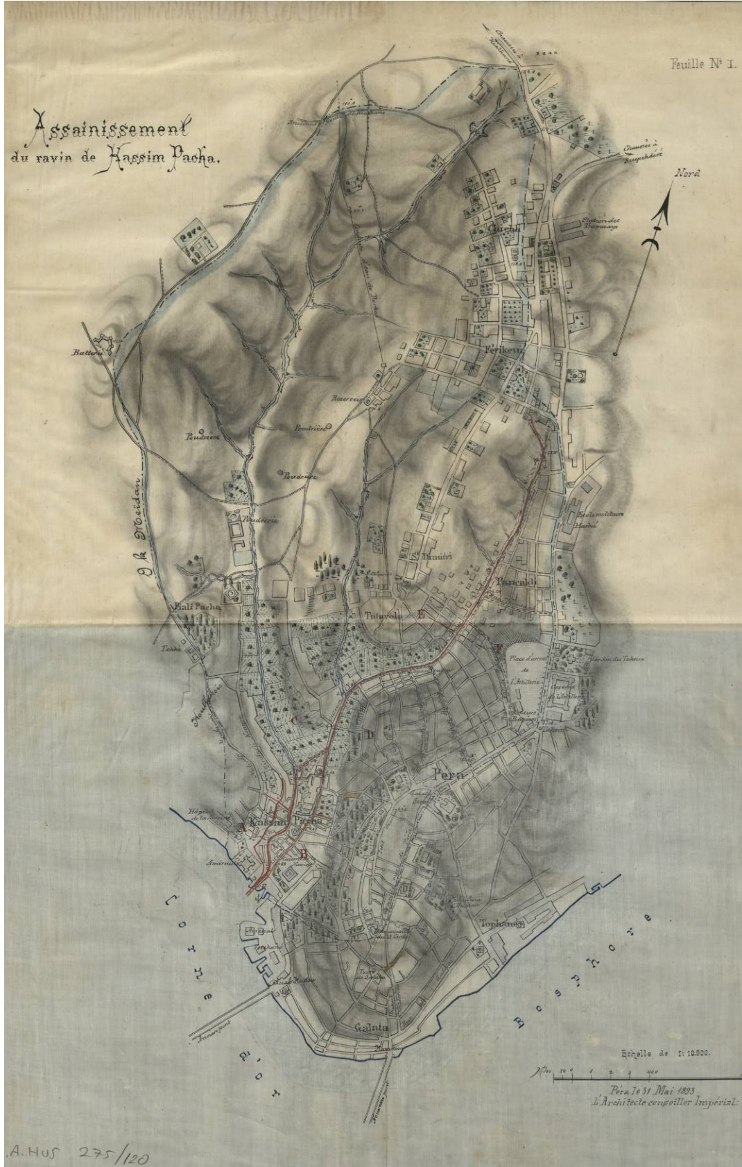
Şekil 3.19 : Kasımpaşa Deresi'nin örtülmesini öneren lağım sistemini gösteren çizim (YA. HUS 275.120.02).
