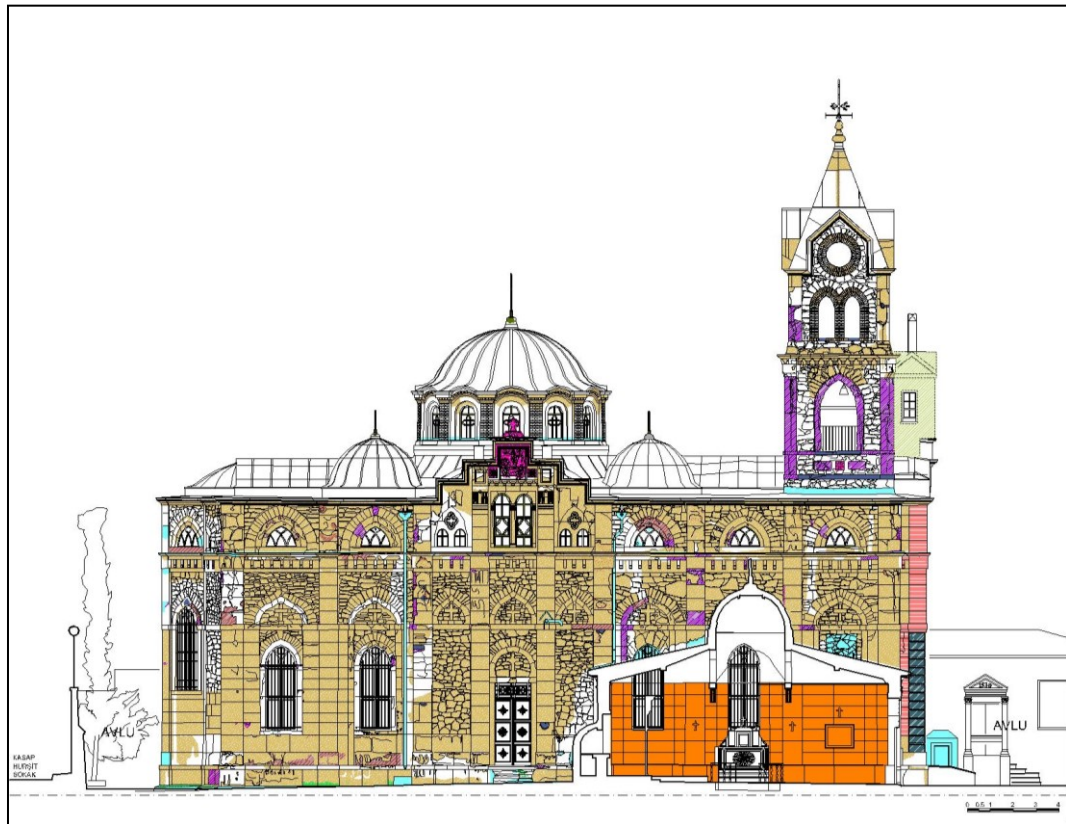
Şekil 4.282 : Evangelistria Kilisesi güneybatı cephesi, koruma önerisi.
