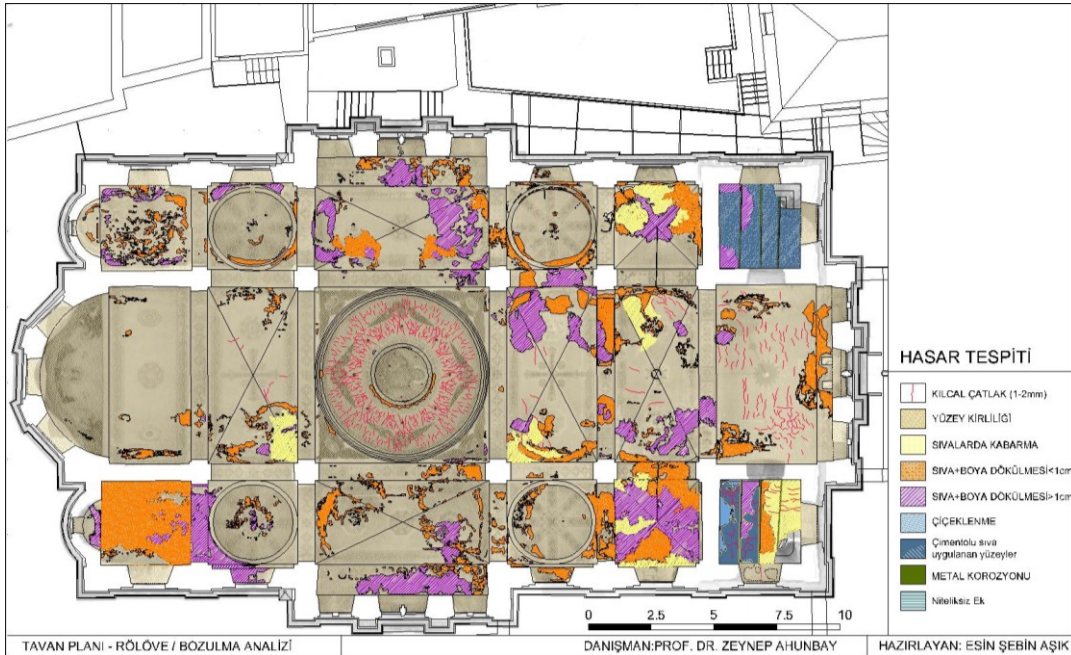
Şekil 4.244 : Tavan planı, bozulma analizi.
