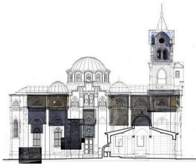
Şekil 4.36 : Laserli total station kullanılarak yürütülen ölçümler sırasında çekilen fotoğraflar ve ölçümleri izleyen çizim aşaması.
