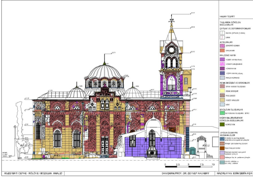
Şekil 4.239 : Kuzeybatı cephesi, bozulma analizi.
