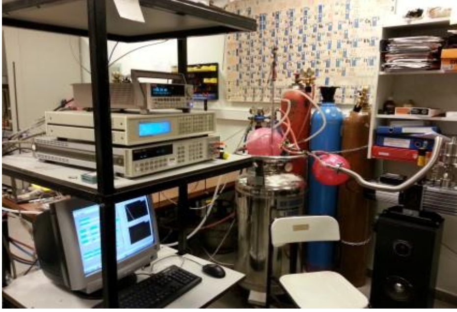
Şekil 3.11. Direnç ölçümleri için kullanılan sistemin fotoğrafı [87]
