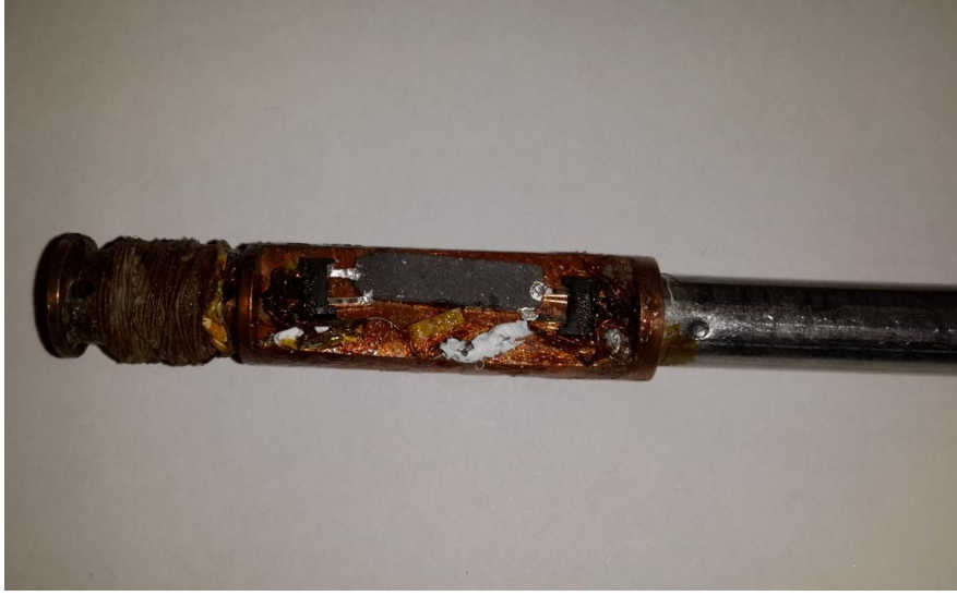
Şekil 3.9. Direnç ölçümleri için kullanılan örnek tutucu ve sabitlenerek kontaktları atılmış örnek
