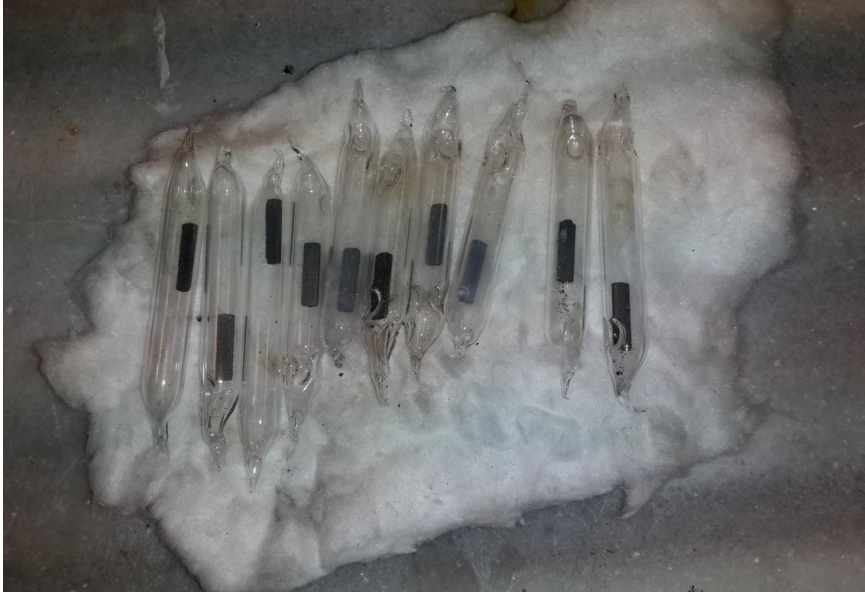
Şekil 3.8. Direnç ölçümü için yeniden şekillendirilerek 850 °C de tavlanmış örnekler
