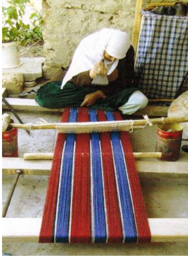
Şekil 42. Yer Tezgâhında Dokuma Yapan Kadın (Ünsal, 2010: 682)
