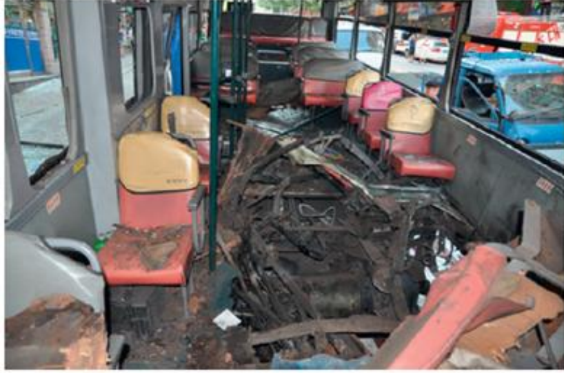
CNG patlaması sonrası otobüsün iç bölgesi
