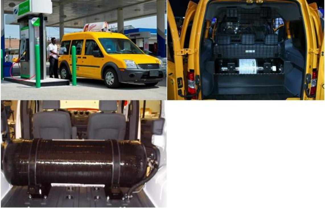
Şekil 6. 14 CNG yakıtlı bir Ford Transit Connect hafif ticari aracı tank yerleşimi
