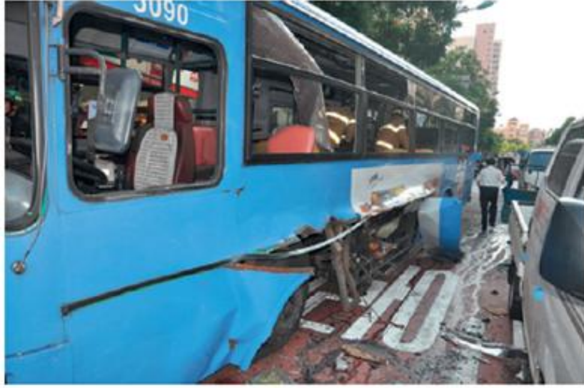
Hasarlı CNG yakıt bölgesi
