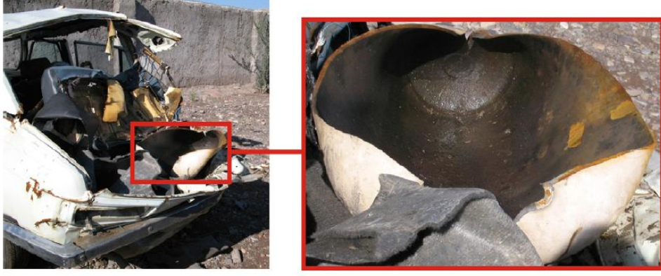
Şekil 6. 5 CNG yakıtlı bir araçta meydana gelen patlama (2009 - İran)
