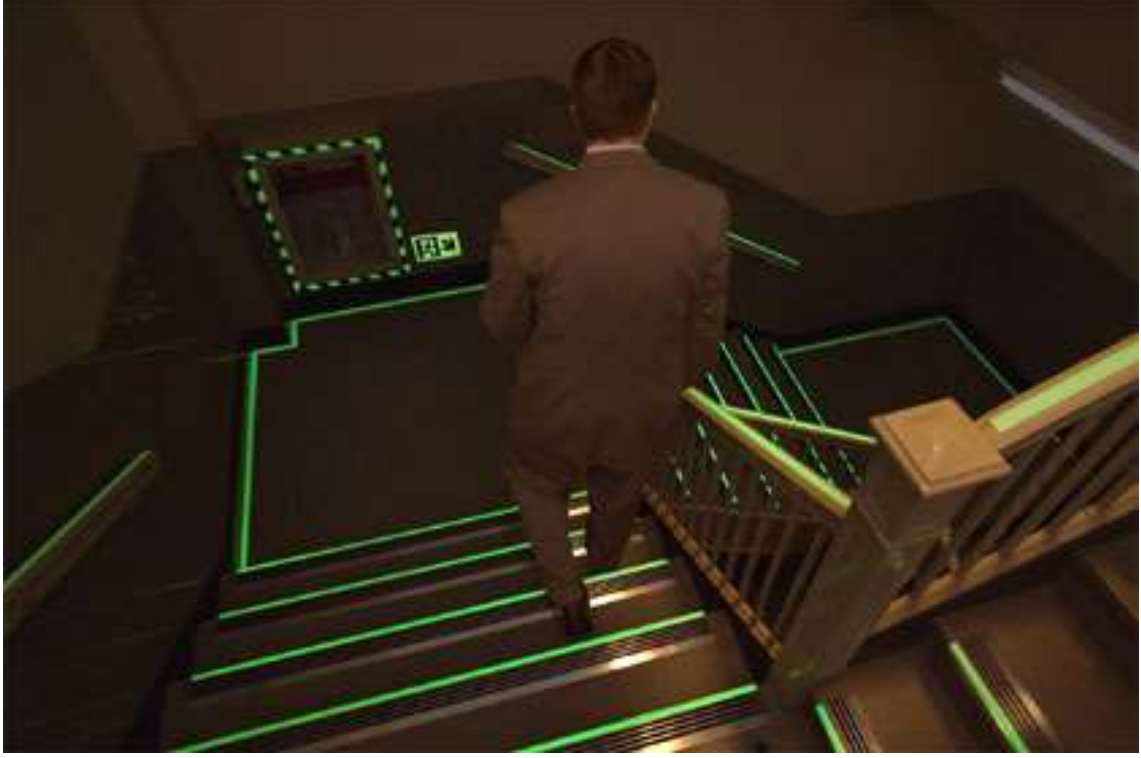
EK-9. Kaçış merdivenlerinde yapılması gereken işaretlemeler
