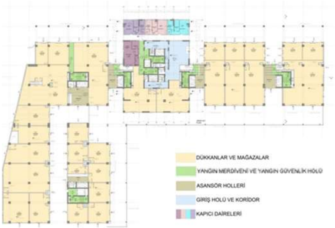
Şekil 4.3. Zemin kat planında diğer bloklarla ilişkisi
