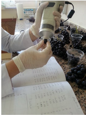
Şekil 3.2.8. Minolta Konica CR-400 kromometre ile renk ölçümleri
