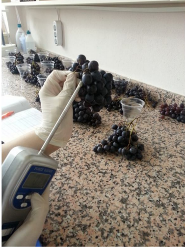
Şekil 3.2.8. Manometre ile tane saptan kopma direncinin tespiti
