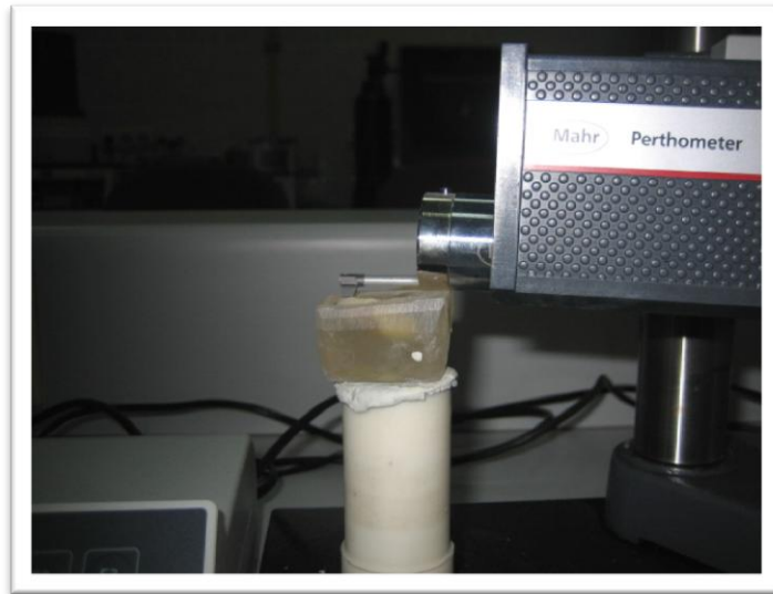
Şekil 3.10. Örnekler üzerine yüzey pürüzlülüğü testi uygulanışı
