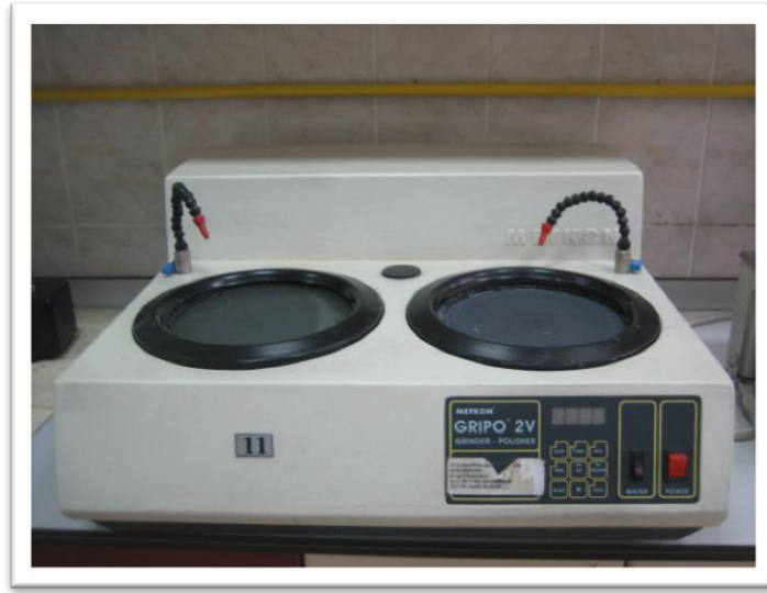
řekil 3.3. Metkon Gripo 2V, tesfiye ve zımparalama cihazı
