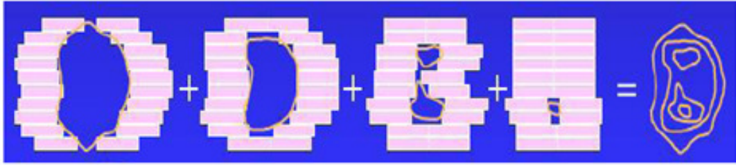
Şekil 2-1: Step and Shoot YART tekniğinin şematik gösterimi
