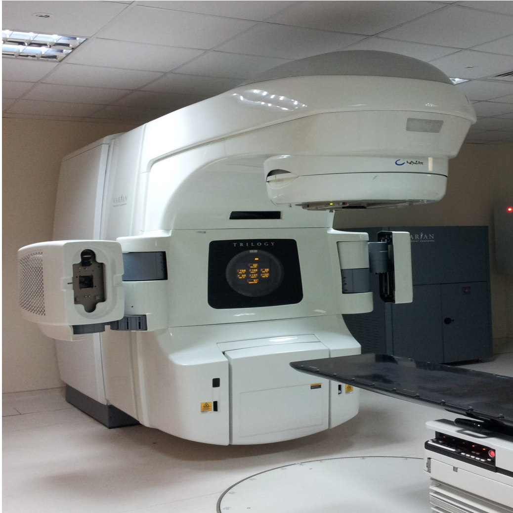
Şekil 2-4: Linak tabanlı radyocerrahi cihazı
