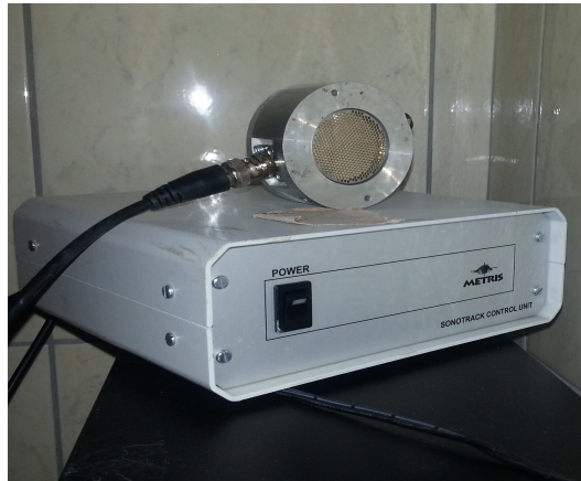
Resim 4: Ultrasonik vokalizasyon kaydı yapmak için kullanılan Sonotrack cihazı
