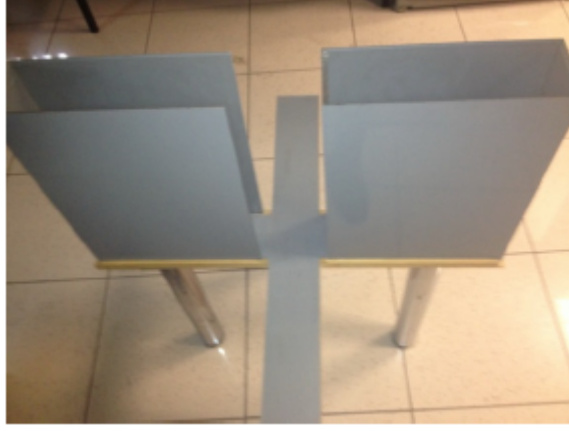
Resim 6: Anksiyete düzeyini ölçmek için kullanılan Yükseltmiş Artı Labirent
