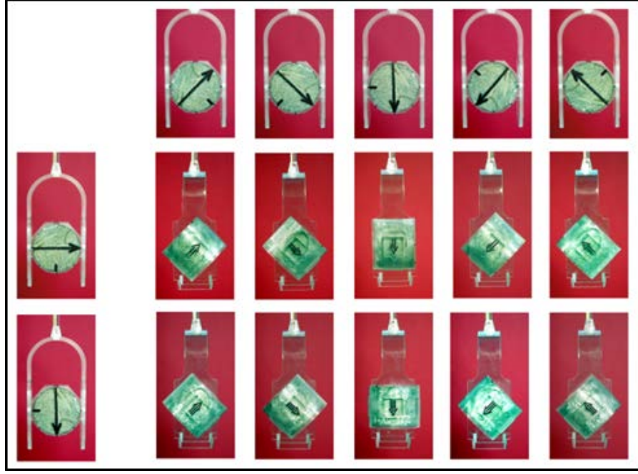
Şekil 3.16: AMS ölçümleri için uygulanan 15 farklı pozisyonun gösterimi.
