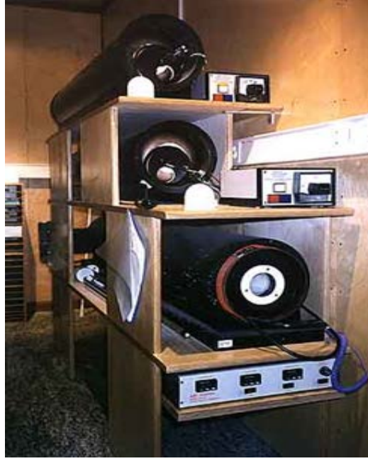
Şekil 3.6: ETH Zürih Üniversitesi Manyetizma Laboratuvarında bulunan termal temizleme cihazı (Schonsted TSD-1).
