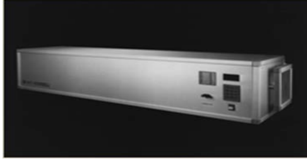
Şekil 3.5: İstanbul Üniversitesi Yılmaz İspir Paleomanyetizma Laboratuvarında bulunan termal temizleme cihazı (MMTD 80).
