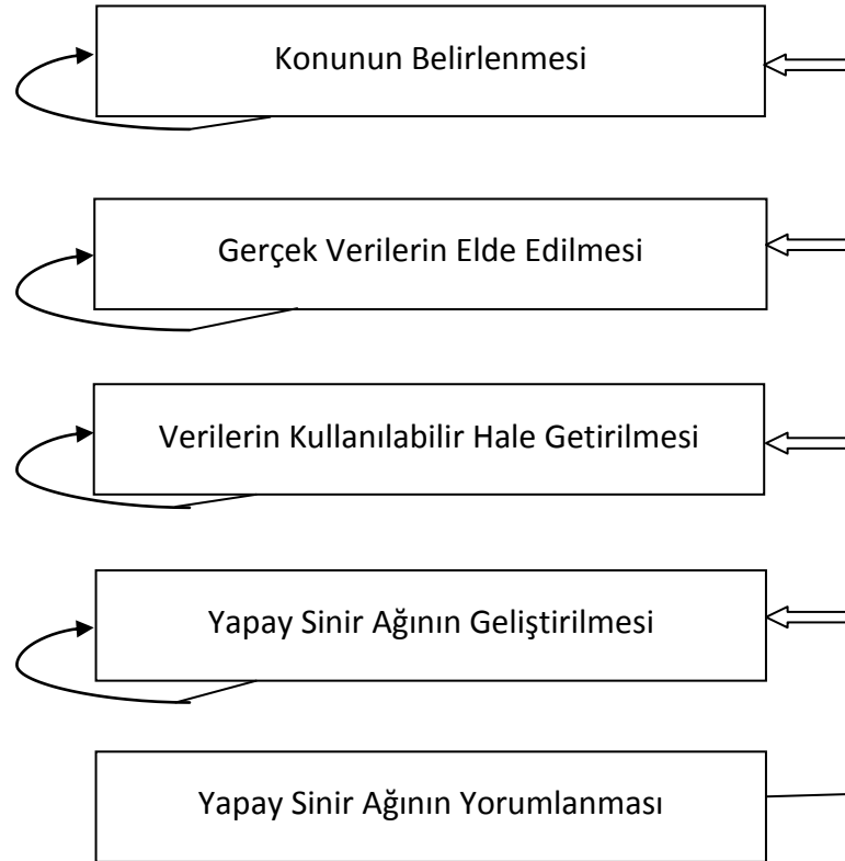
Şekil 4. 2 Ağ oluşturma genel işlem basamağı algoritması
