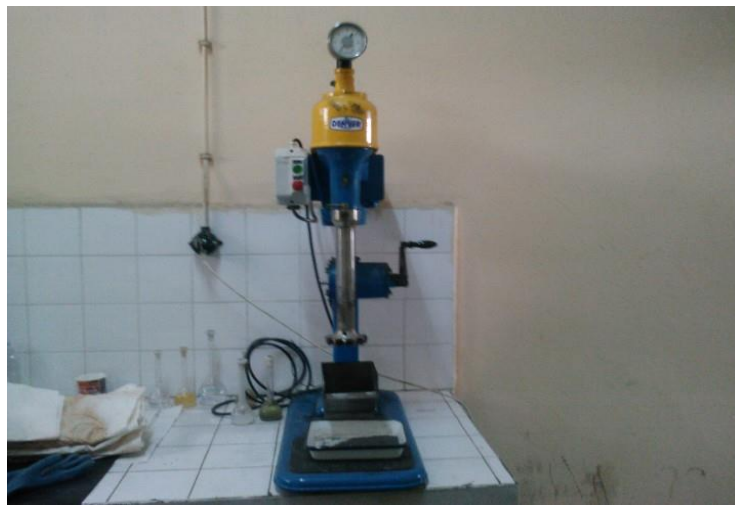
Şekil 2.13 Denver tipi flotasyon makinesi.
