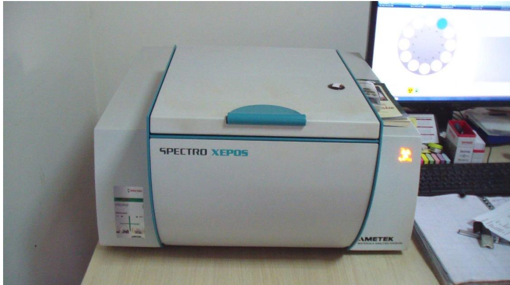
Şekil 2.12 Spectro Xepos XRF cihazı.
