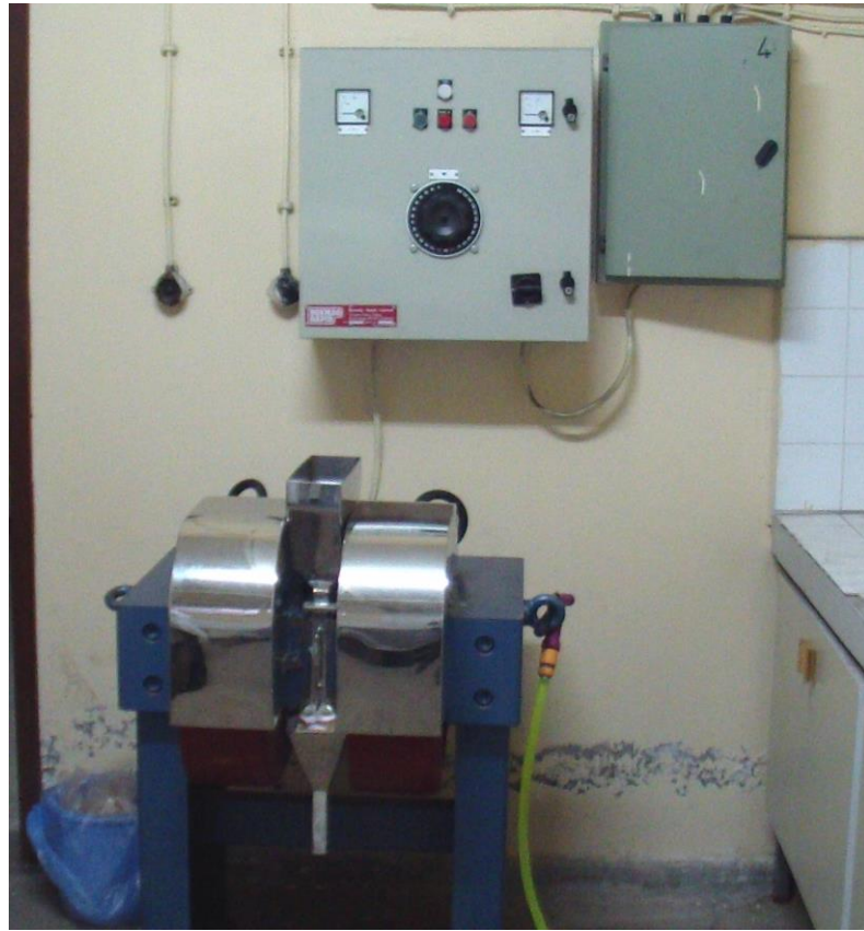
Şekil 2.14 Boxmag Rapid yüksek alan şiddetli laboratuvar tipi yaş manyetik ayırıcı.
