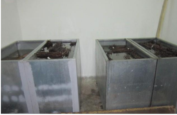
Şekil 3.2. Çeliklerin tanklarda 48 ve 96 saat bekletilmesi
