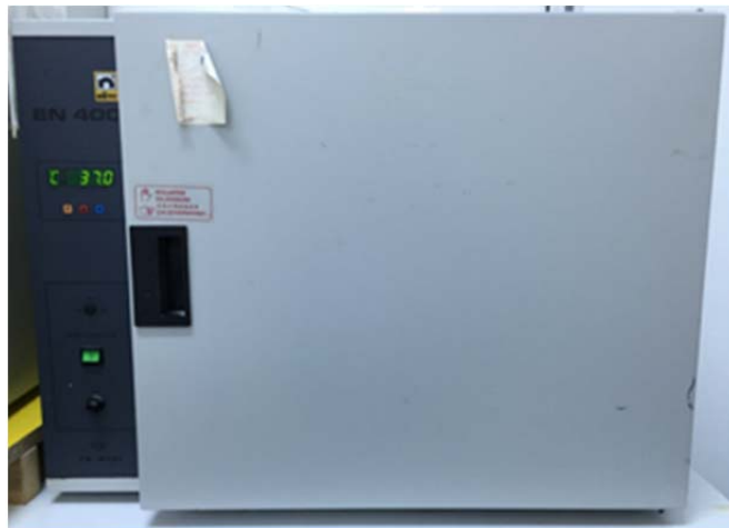
Resim 11. Örneklerin 37 C°'de saklanması için kullanılan etüv
