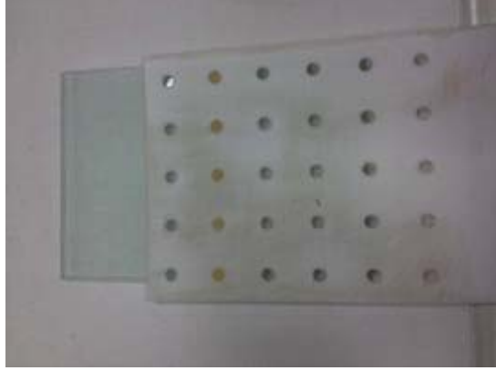
Resim 7. Örneklerin hazırlanmasında kullanılan teflon kalıp
