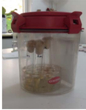
Resim 18. Bakteri inokulumlarının konulduğu anaerob jar
