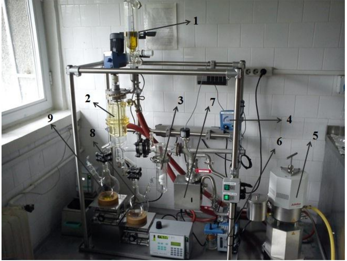
Şekil 3.2 Araştırmada kullanılan laboratuvar ölçekli kısa yollu (short path) destilasyon sistemi
