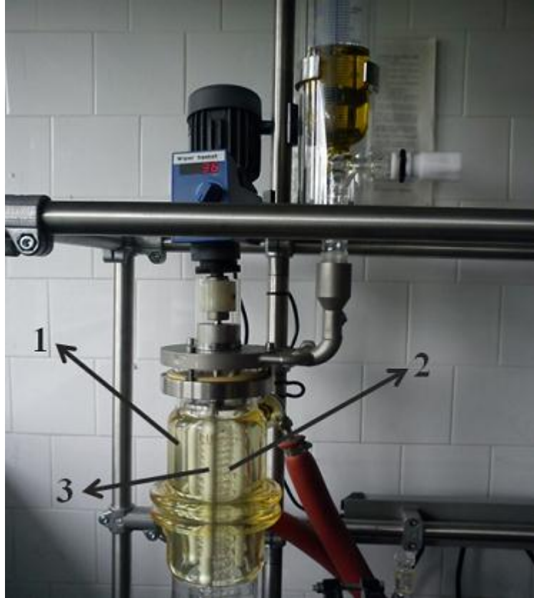
Şekil 2.4 Kısa yollu (short path) evaporatör (1:Isıtıcı, 2:Yoğunlaştırıcı, 3:Sıvayıcı kollar)
