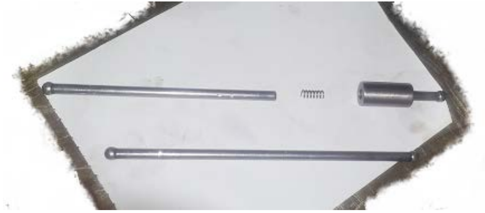
Şekil 4.3 Revizyon yapılmış külbütör çubuğu ve orijinal külbütör çubuğu
