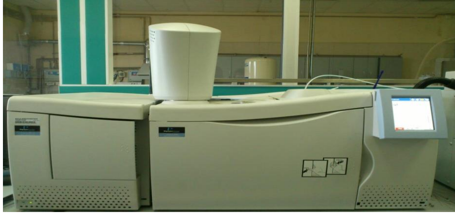
Şekil 3.9 Perkin Elmer Clarus 500 gaz kromatografi cihazı
