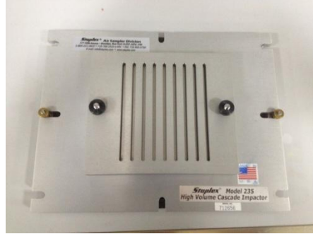
Şekil 3.3 Basamaklı ayırıştırıcı filtre düzeneği
