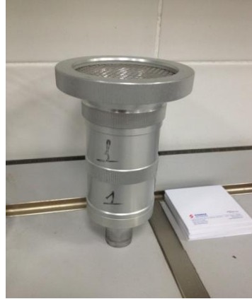
Şekil 3.2 TSP cihazı örnekleme başlığı
