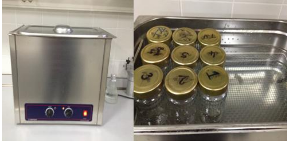
Şekil 3.5 Ultrasonik banyo düzeneğinde filtrelerin ekstraksiyonu
