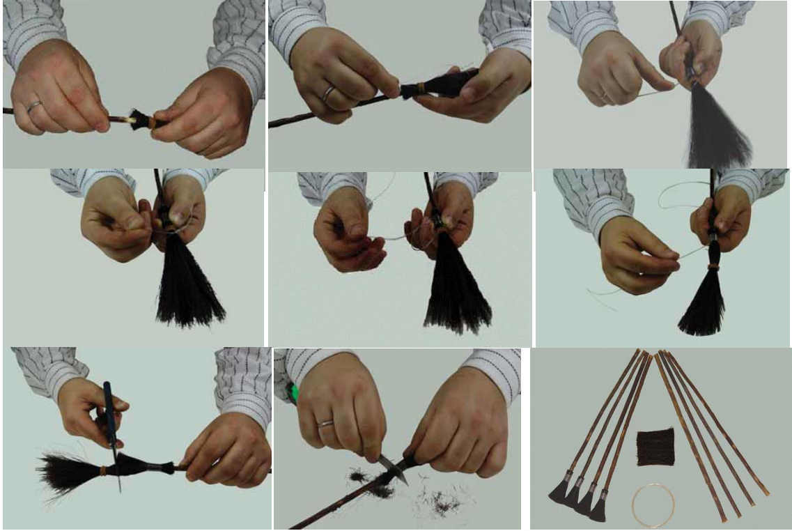
Şekil 32. Ebru fırçasının bağlanması (Dere, s. 65)
