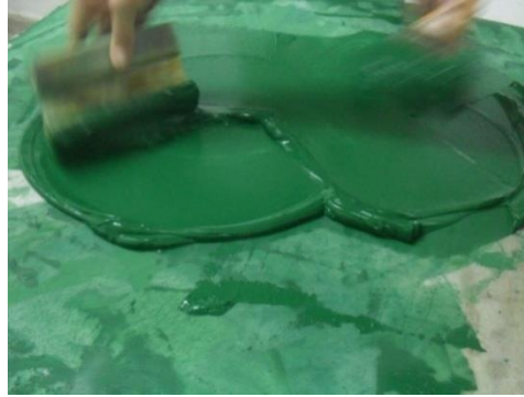
Şekil 40. Toprak boyanın destiseng yardımıyla ezilmesi ( http://3penses.blogspot.com )
