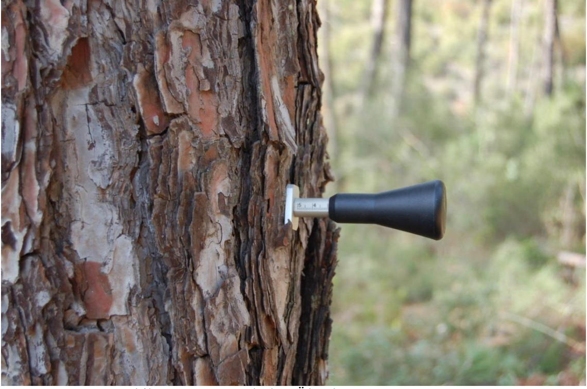
Şekil 3.5. Kabuk Kalınlığı Ölçerken (Koparan, 2014)
