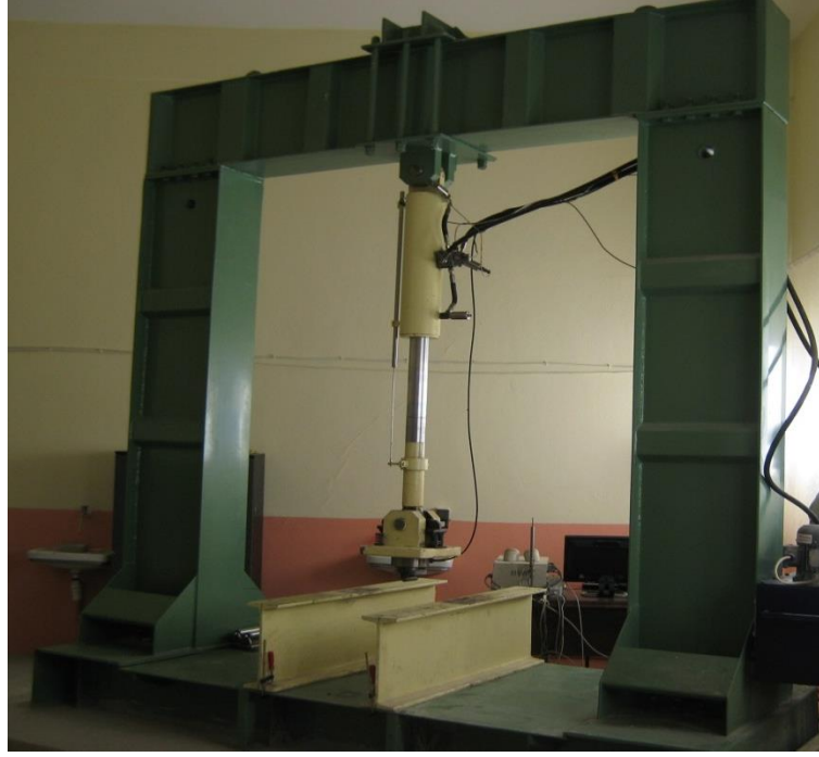
Şekil 3.3. Kiriş numunelerin kırıldığı eğilme çerçevesi
