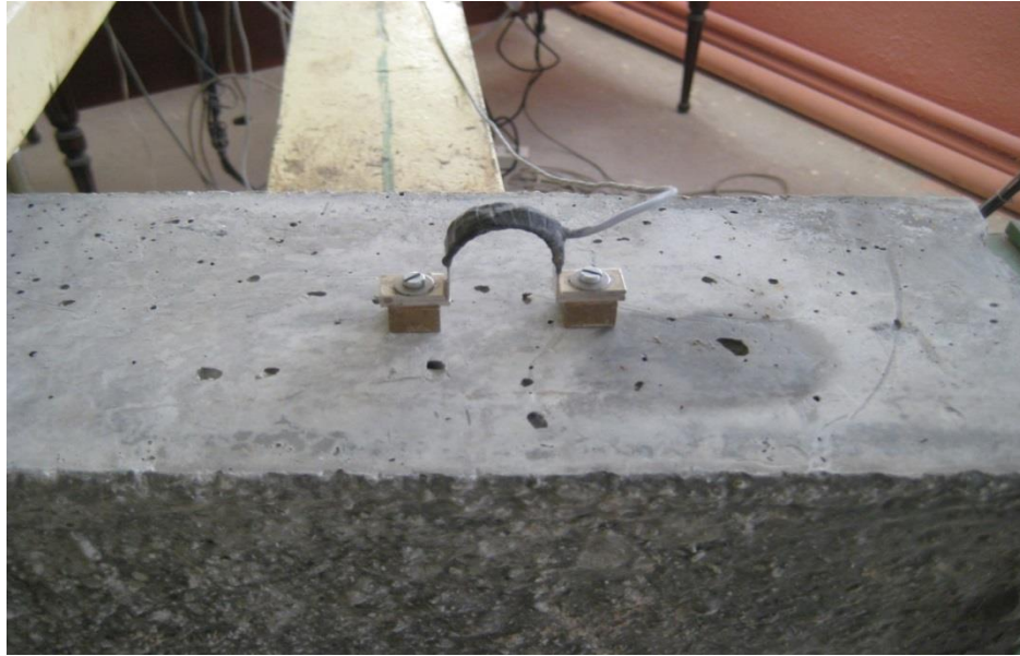
Şekil 3.2. Çatlak Genişliğini ölçmek için kullanılan düzenek
