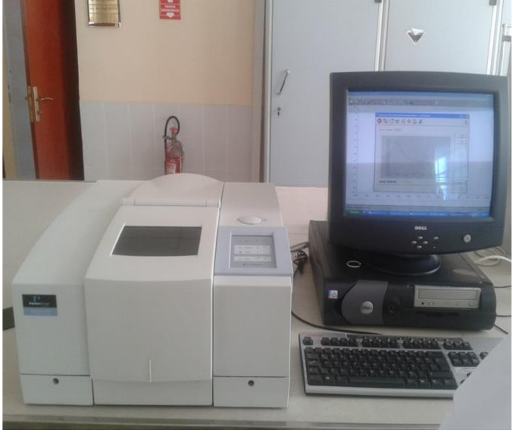
Şekil 3.11. FTIR analizi için kullanılan cihaz (Perkin-Elmer, Llantrisant, UK).
