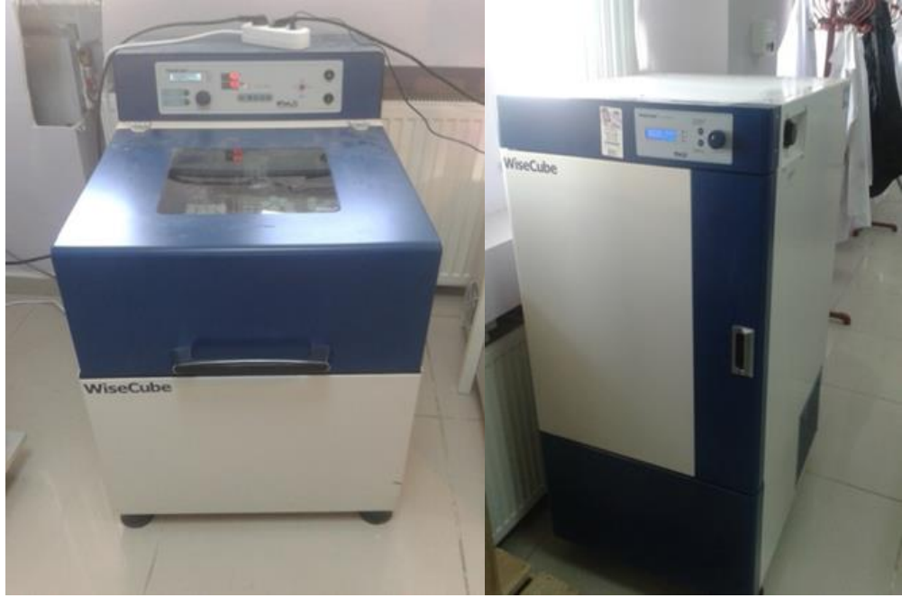
Şekil 3.2. Örneklerin çoğaltılmasında kullanılan çalkalamalı ve normal inkübatörler
