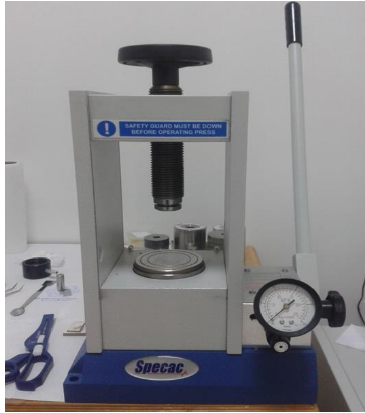
Şekil 3.9. FTIR analizi için disk hazırlamada kullanılan pres
