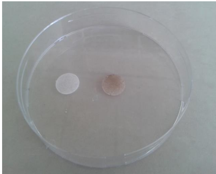
Şekil 3.10. Kitosandan hazırlanan ince diskler (10mm çap)
