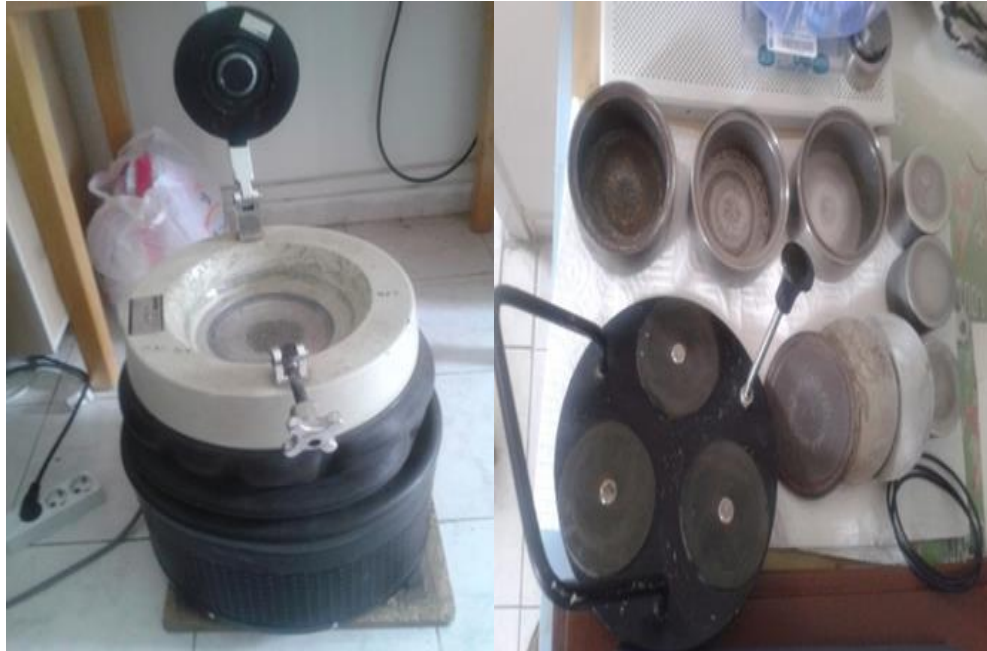
Şekil 3.5. Kurutulan biyokütlenin öğütülmesi ve kullanılan öğütücü
