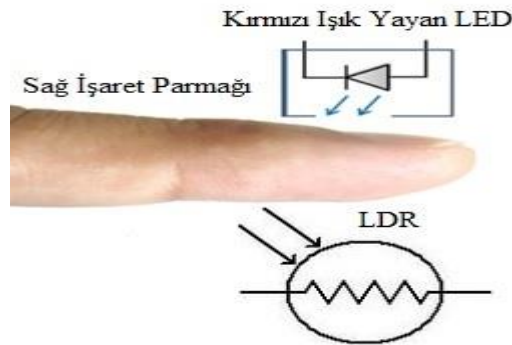
Şekil 2.9. PPG sensörü çalışma prensibi
