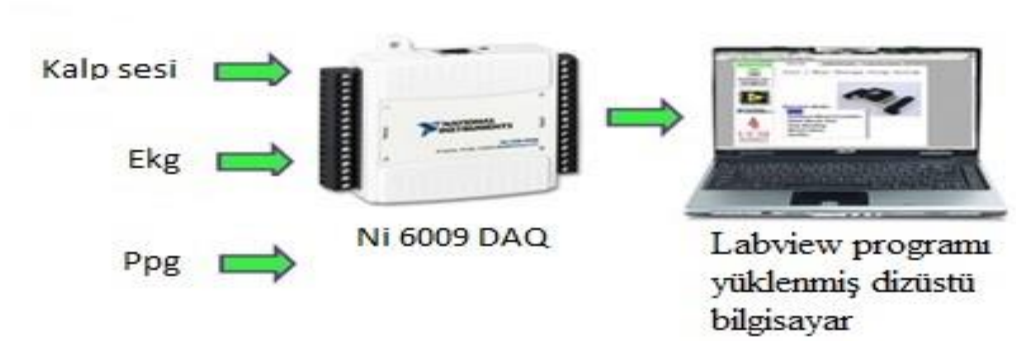
Şekil 3.2. Kayıt devreleri blok şeması
