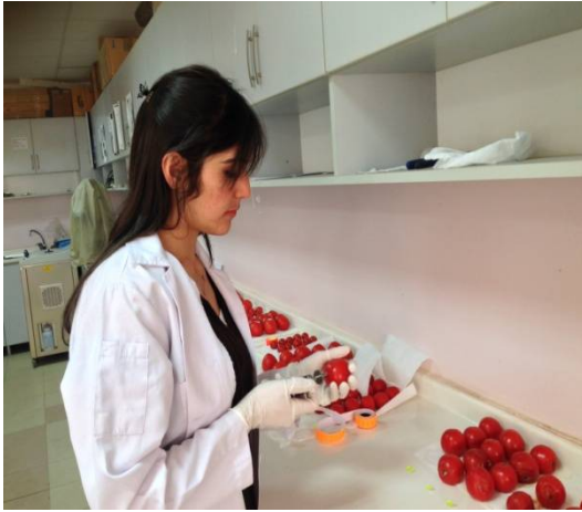
Şekil 3. 8. Penetrometre ile meyve sertliğinin ölçülmesi.
