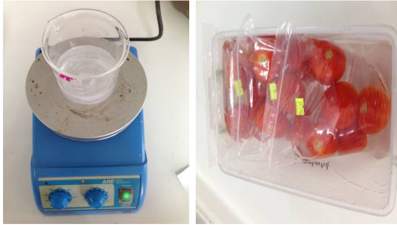
Şekil 3. 3. SA'nin çözülmesi ve domates meyvelerinin SA çözeltisinde bekletilmesi.
