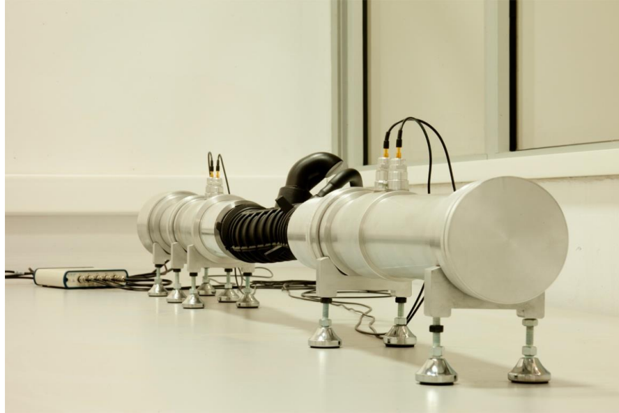
Şekil 4.4 : Empedans Tüpü Deney Düzeneği.
