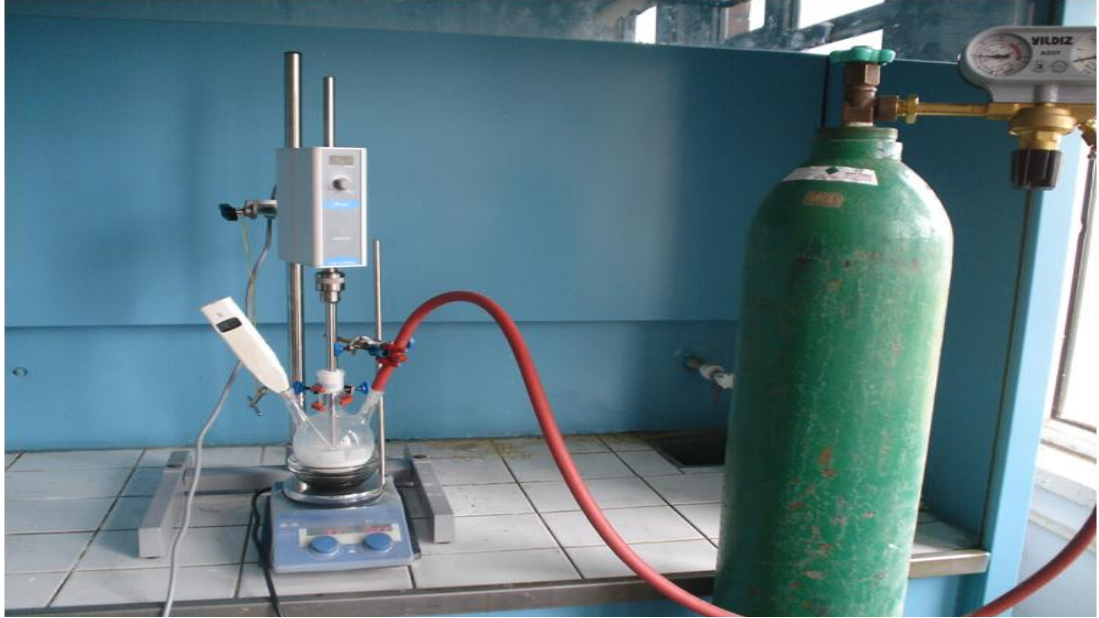
Şekil 4.1. PAA kabuklu ve poliöl veya ötektik bileşimli poliöl karışımı içeren mikro/nanokapsüllerin sentezi için oluşturulan deney düzeneği
