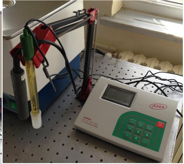
Şekil 2.6 Nanoakışkanların hazırlanmasında kullanılan makine-teçhizat a) hassas elektronik terazi, b) sonifikatör banyosu, c) sabit sıcaklık su banyosu, d) pH ölçer.
