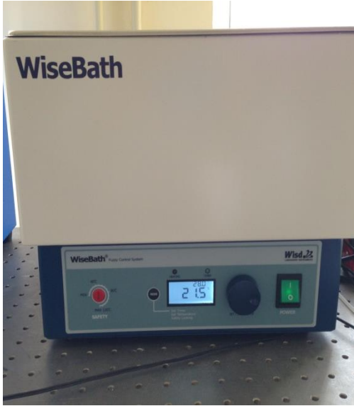
Şekil 2.6 Nanoakışkanların hazırlanmasında kullanılan makine-teçhizat a) hassas elektronik terazi, b) sonifikatör banyosu, c) sabit sıcaklık su banyosu, d) pH ölçer.
