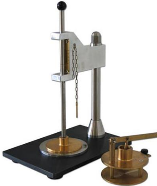
Şekil 3.10. Pfefferkorn test düzeneği (Anonim, 2015)
