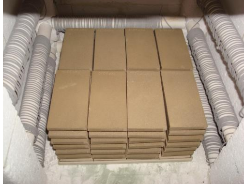
Şekil 3.8. Pres ile kuru şekillendirilmiş tabletler
