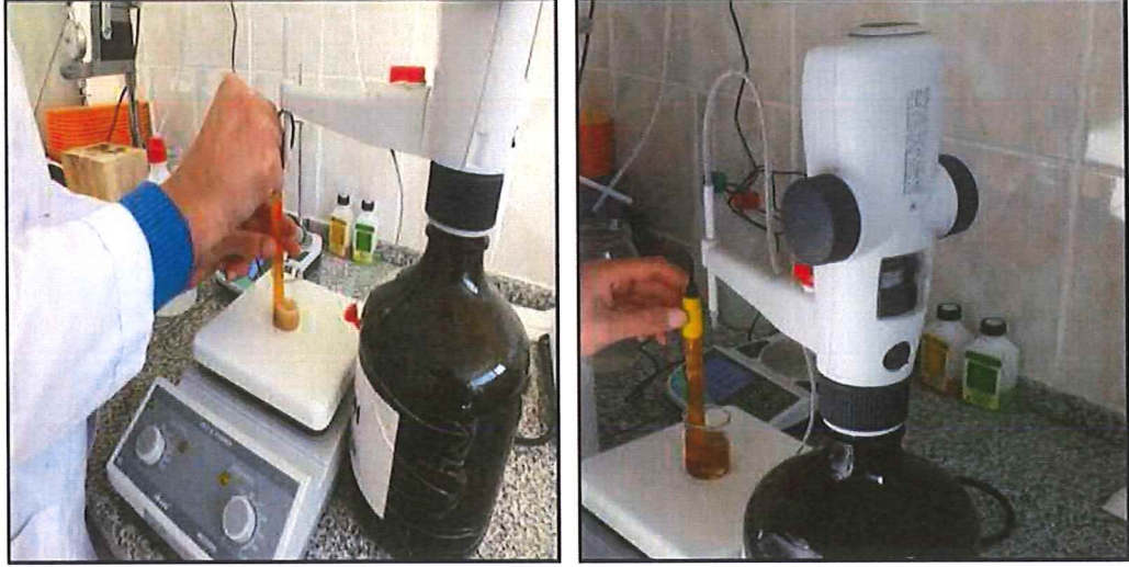
Şekil 3.10. Malik asit cinsinden titre edilebilir asitlik ölçümü
