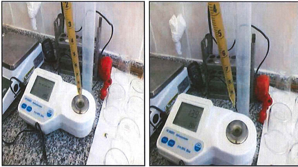
Şekil 3.8. Suda çözünür kuru madde miktarı ölçümü
