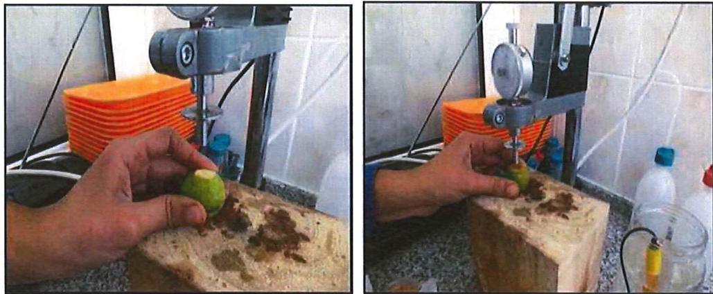
Şekil 3.7. Meyve eti sertlik ölçümü
