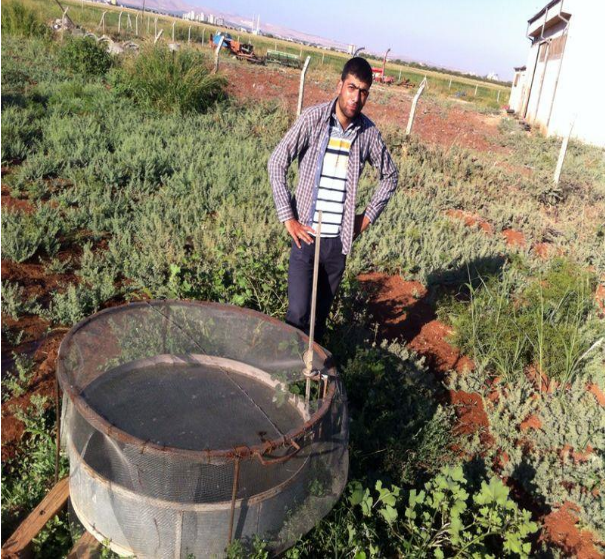
Şekil.3.4. Denemede kullanılan A sınıfı buharlaşma kabı
