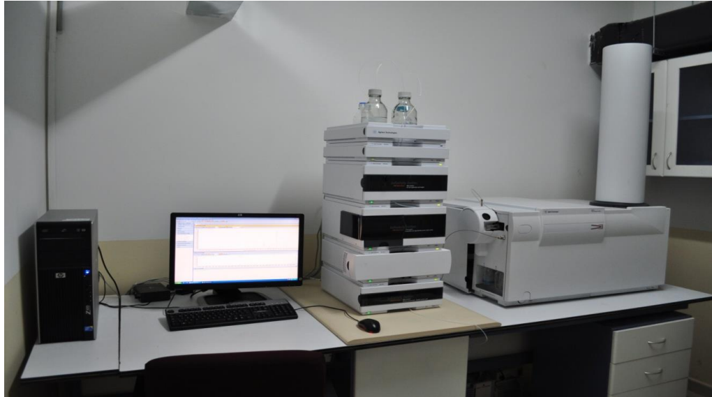
Şekil 3. 2. Fenolik bileşiklerin kantitatif analizlerinin yapıldığı LC-TOF cihazı (Liquid Chromatography- Time of Flying)
