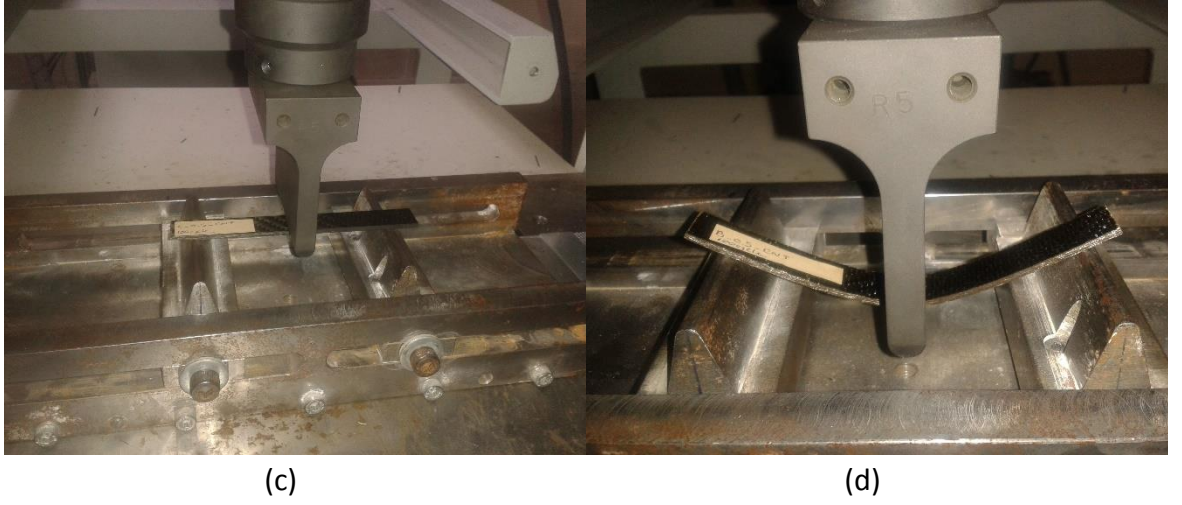
Şekil 3.27. Eğilme deneyi düzeneği a) Çekme cihazı, b) veri kayıt düzeneği, c) yük uygulama burnunun ayarlanması, d) numuneye eğilme yükünün uygulanması
