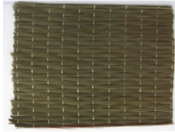
Şekil 2.1. Tekyönlü bazalt kumaşı (Fiore et al. 2011)
