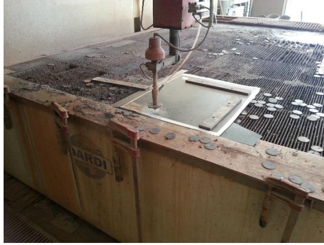
Şekil 3.18. Üretilen plakların kesim aşaması
