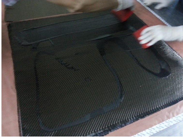
Şekil 3.8. Reçinenin el-yatırma ile kumaşlara emdirilmesi
