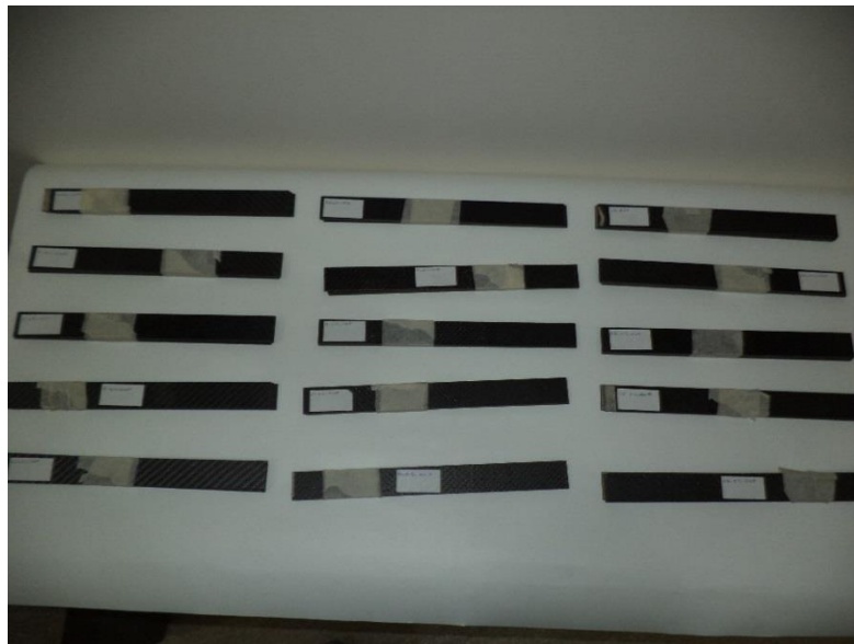
Şekil 3.32. Titreşim deneyinde kullanılan numuneler
