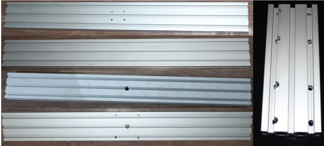
Şekil 4.19 İşlenmiş sigma profiller.
