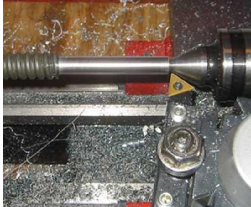
Şekil 4.23 Vidalı milin tornalanması.
