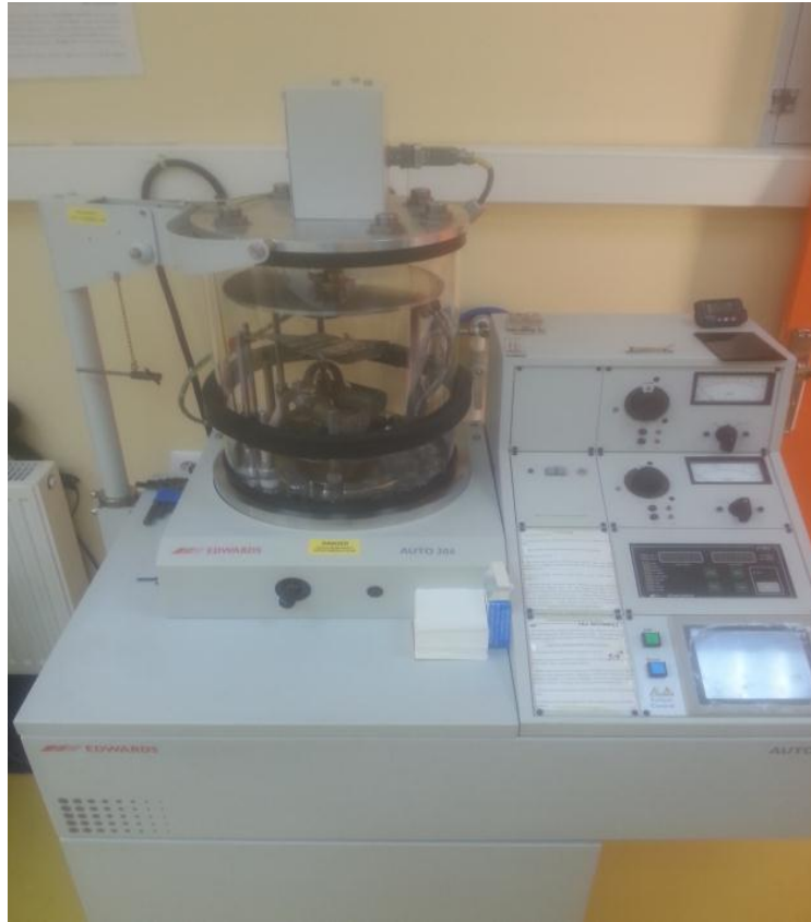
Şekil 4.6. Omik ve Schottky kontak için kullanılan buharlaştırma sistemi.
