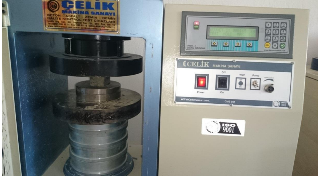
Şekil 6.8. Tek eksenli basınç dayanımı deneyinin yapıldığı hidrolik pres ve deney düzeneği
