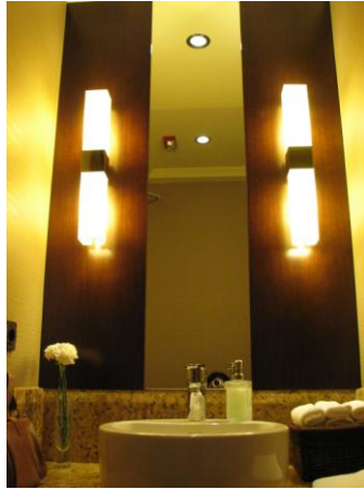
Şekil 5. 14 Aynanın her iki yanında birer doğrusal aydınlatma aygıtı ile kurulan aydınlatma düzeni, Alternatif-13
