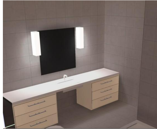
Şekil 5. 10 Aynanın her iki yanında birer noktasal aydınlatma aygıtı ile kurulan aydınlatma düzeni, Alternatif-9
