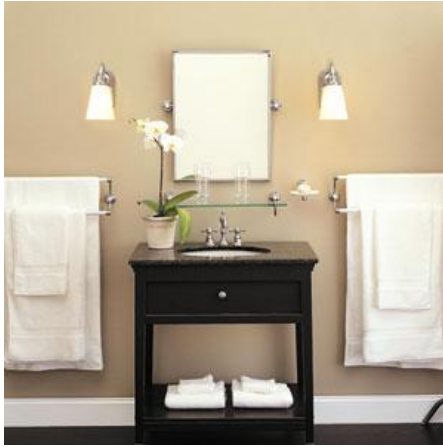
Şekil 5. 10 Aynanın her iki yanında birer noktasal aydınlatma aygıtı ile kurulan aydınlatma düzeni, Alternatif-9
