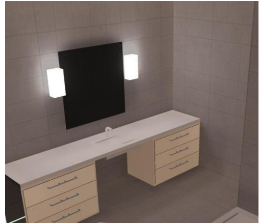
Şekil 5. 8 Aynanın her iki yanında birer noktasal aydınlatma aygıtı ile kurulan aydınlatma düzeni, Alternatif-7
