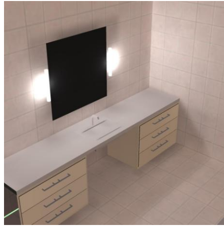
Şekil 5. 14 Aynanın her iki yanında birer doğrusal aydınlatma aygıtı ile kurulan aydınlatma düzeni, Alternatif-13
