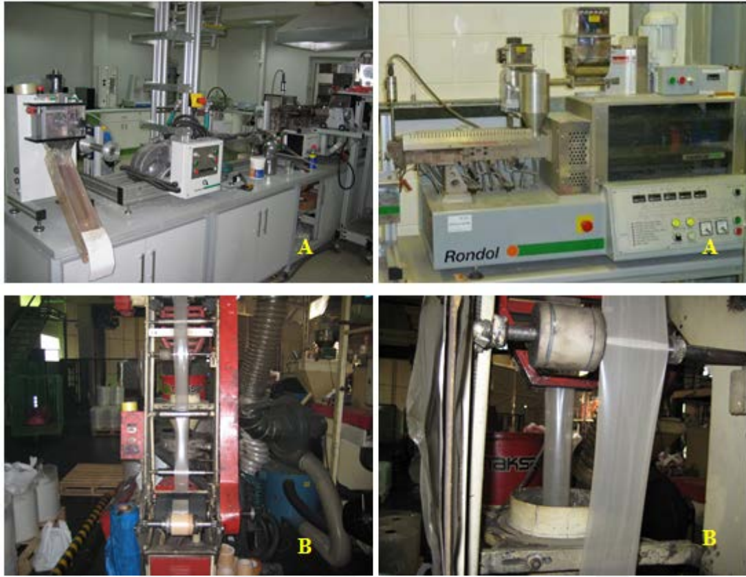
Şekil 3.2. Film üretiminde kullanılan ekstrüderlerin görüntüsü (A: Çift vidalı; B: Tek vidalı ekstruder)
