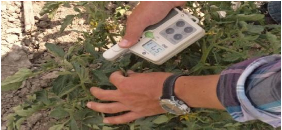
Şekil 3.19. SPAD metre ile kloroz durumunun belirlenmesi
