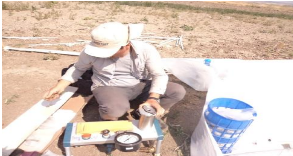
Şekil 3.15. Yaprak su potansiyeli ölçümünde kullanılan taşınabilir basınç çemberi
