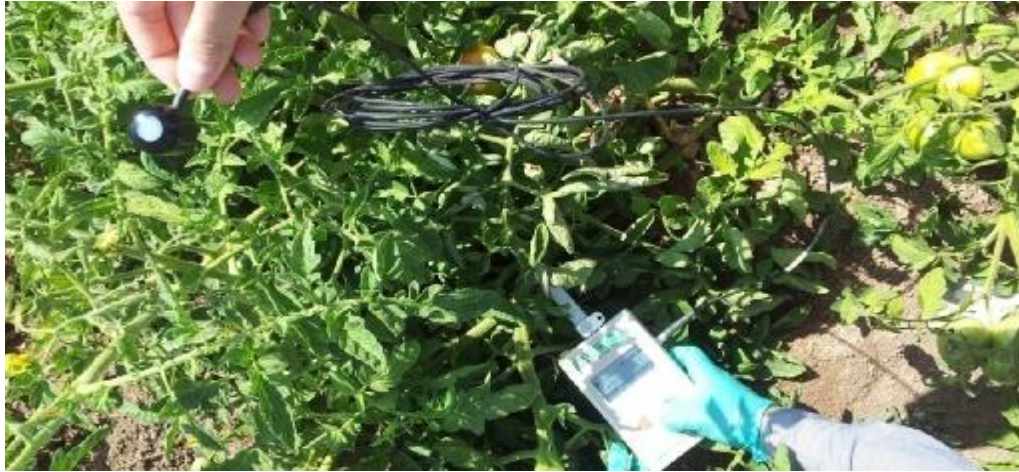
Şekil 3.17. Enstitü (kontrol) lokasyonunda yaprak alan indeksi (LAI) ölçümü
