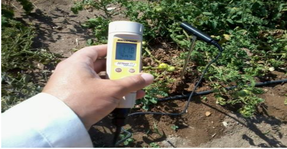
Şekil 3.8. Bitki kök bölgesinde doğrudan toprak EC ölçümünün yapılması
