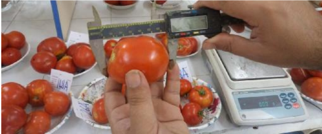
Şekil 3.25. Meyve çapı ve boyunun belirlenmesi
