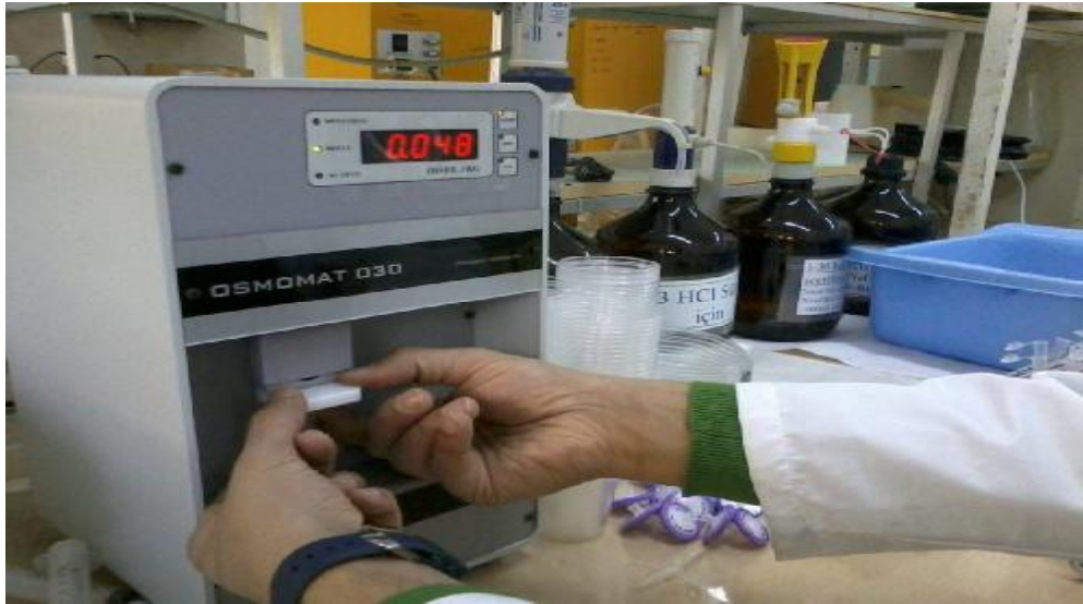
Şekil 3.16. Yaprak ozmotik potansiyel ölçümü
