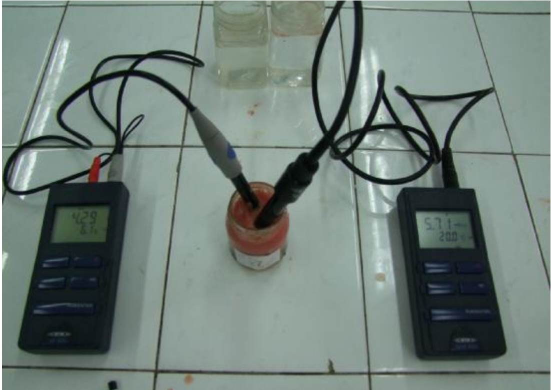
Şekil 3.20. Meyve suyunda pH (sol) ve EC (sağ) değerlerinin belirlenmesi
