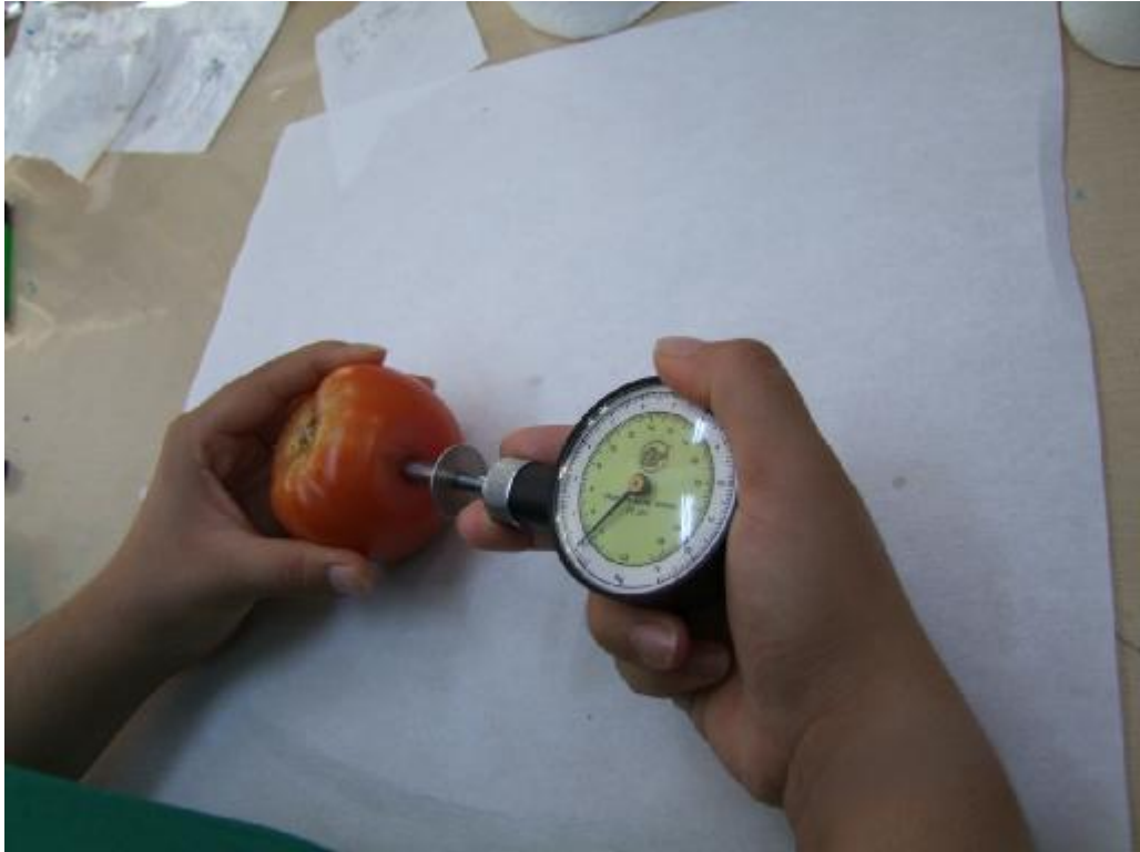
Şekil 3.17. Domates meyvesinde penatrometre ile sertlik ölçülmesi
