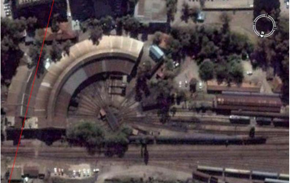
Şekil 5. 195 Adana İstasyonu'ndaki dairesel planlı lokomotif deposu vaziyet planı [65].
