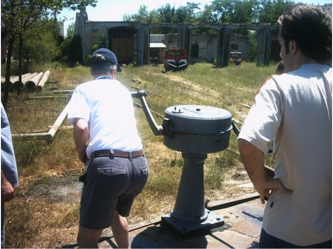
Şekil 5. 337 Çerkezköy Dairesel Planlı Lokomotif Deposu dönerköprüsü, manuel olarak kullanılan bu dönerköprü iki kişinin kol kuvvetiyle 360 derece dönebiliyor [164].
