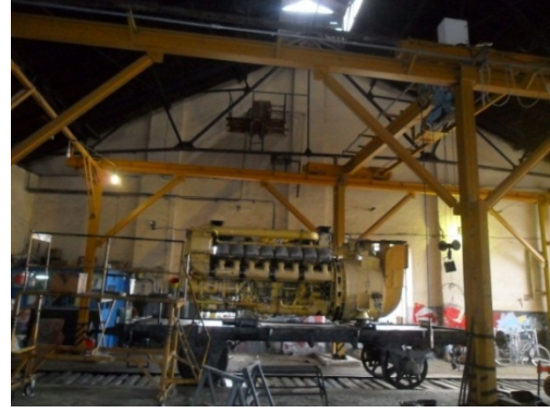
Şekil 5. 93 İç mekân, 1 ve 2 nolu hattın bulunduğu bölümün, çatı makasları ve çatı aydınlığı, lokomotif tamir ekipmanları
