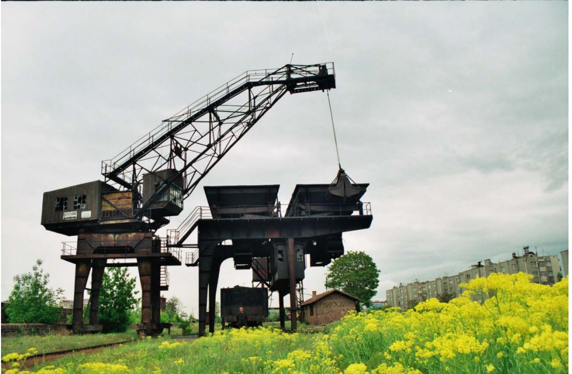
Şekil 5. 276 Kayseri İstasyonu'ndaki dairesel planlı lokomotif deposu arka bölümünde yer alan, bugün mevcut olmayan kömür rıhtımları ve yükleme tesisatı [160].
