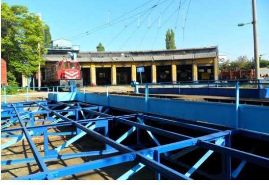
Şekil 5. 31 Krupp marka dönerköprü, lokomotifin taşındığı raylar ve taşıyıcı kirişler
