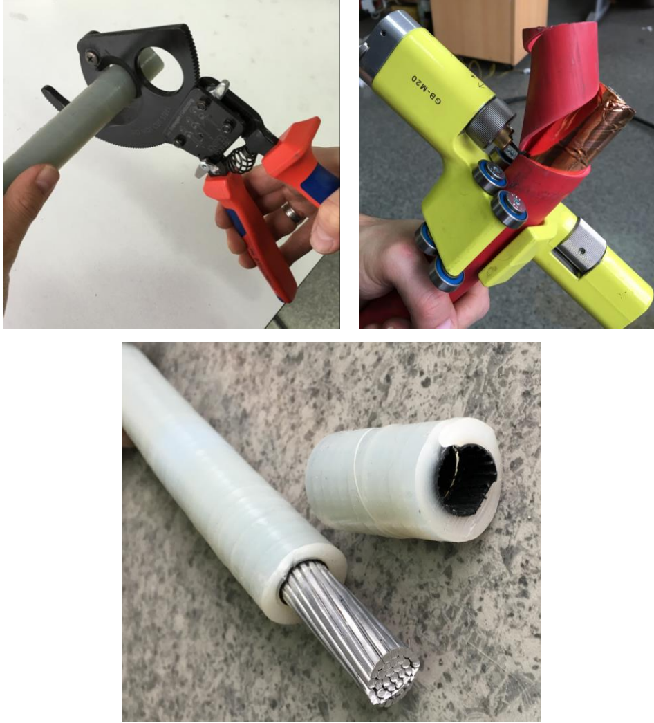
Şekil 2.5 Kablo numunesinin test için hazırlanma aşamaları
