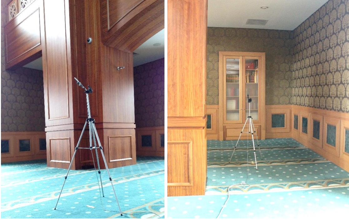
Resim 4.6. Hasan Tanık Camii ölçüm anında mikrofön yerlerinden örnekler [18]
