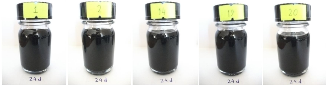
Şekil 2.18 Homojen karışımın 576 saat (24 gün) sonunda devam ettiği numune örnekleri.
