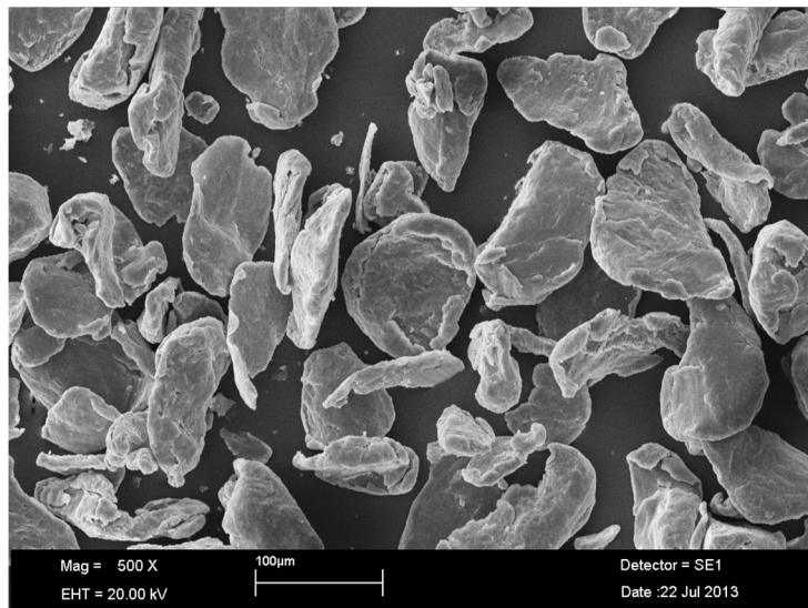
Şekil 2.3 Magnezyum tozu SEM görüntüsü.
