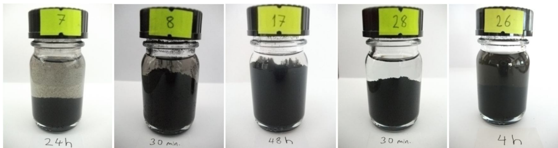
Şekil 2.17 Homojen karışımın elde edilemediği numunelerden örnekler.
