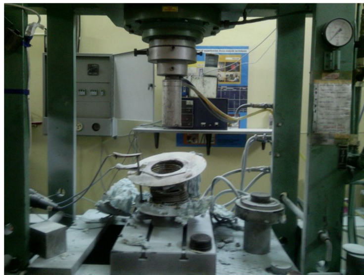
Şekil 2.20 Patlama sonrası sinterleme fırını görüntüsü.
