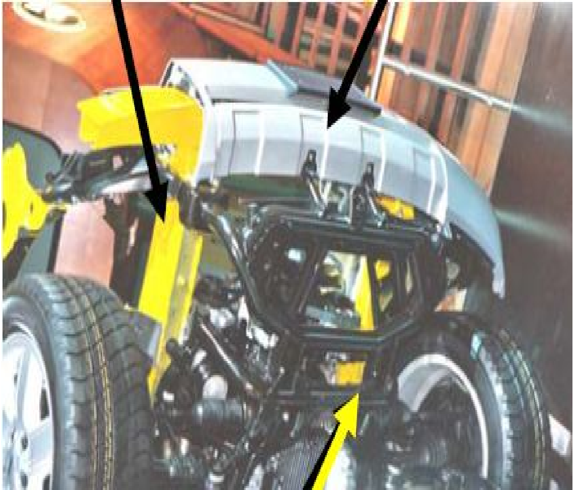
Şekil 1.2 Araçların ön kısmında potansiyel magnezyum uygulama alanları [3]
