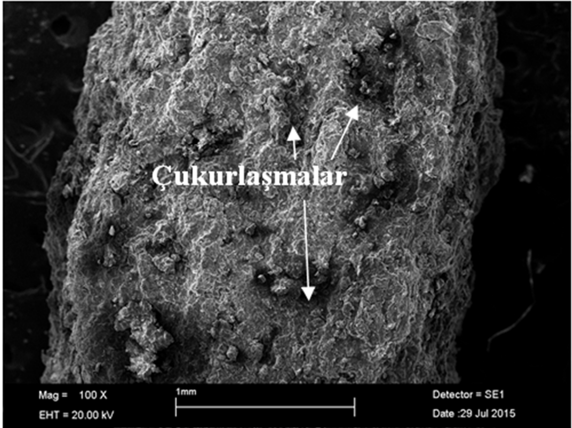
Şekil 3.144 25 numaralı numunenin korozyon testi sonrası yüzey görüntüsü.
