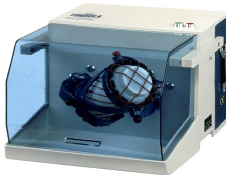
Şekil 2.6 Turbula T2F karıştırıcı
