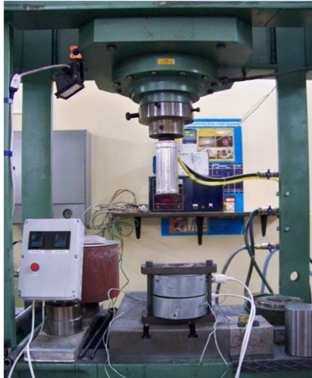
Şekil 2.11 Toz sıkıştırma işleminde kullanılan 250 tonluk hidrolik pres
