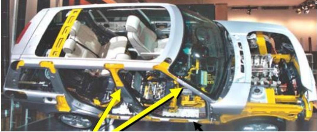
Şekil 1.3 Araçların ön ve üst kısımlarında potansiyel magnezyum uygulama alanları [3]
