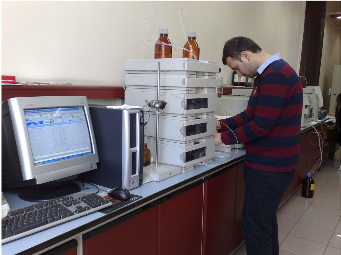
Şekil 6. Domoik asit analizlerinin yapıldığı HPLC-FLD cihazı görüntüsü
